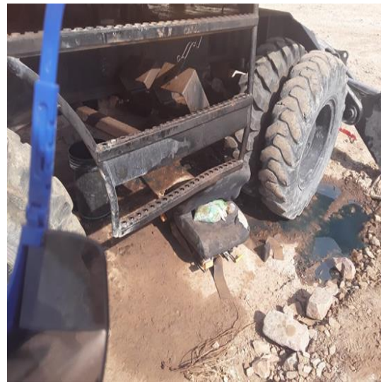
Figura 12. Fuga y derrame de aceites y grasas por parte de la maquinaria.
