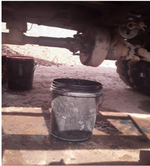
Figura 12. Fuga y derrame de aceites y grasas por parte de la maquinaria.
