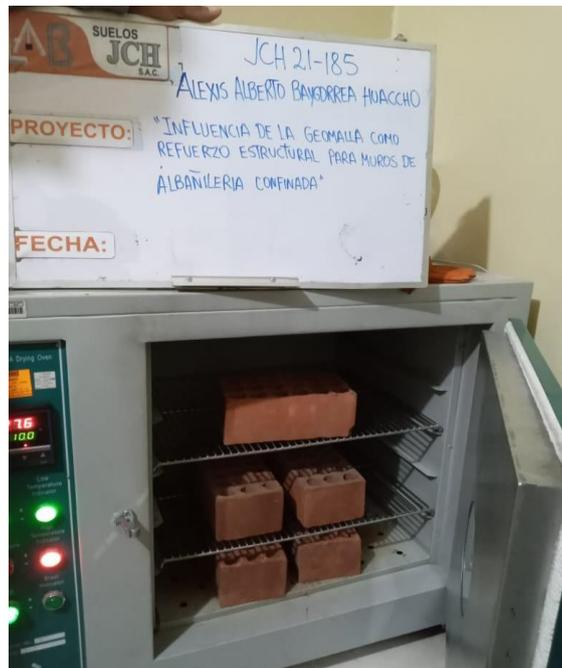
Figura N°30: Muestras colocadas en horno
