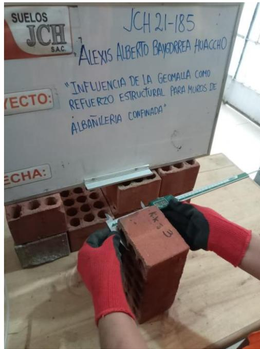
Figura N°27: Ensayo de variación dimensional
