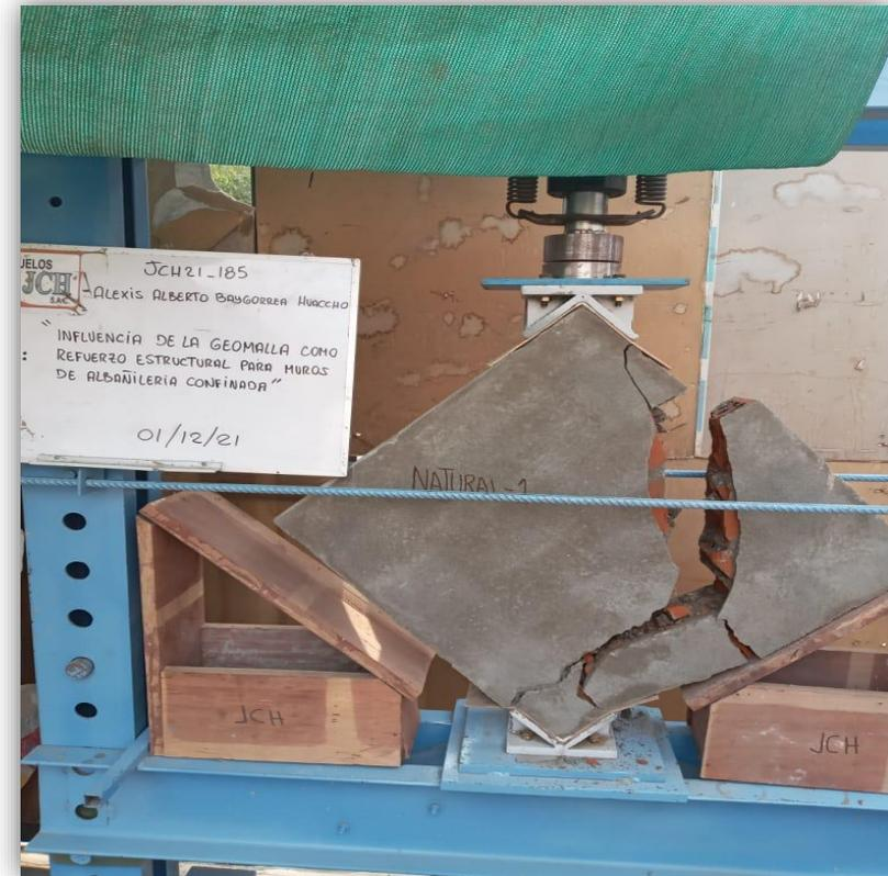
**ENSAYO DEL MURETE N°2 SIN REFUERZO DE LA GEOMALLA BIAIXIAL**
