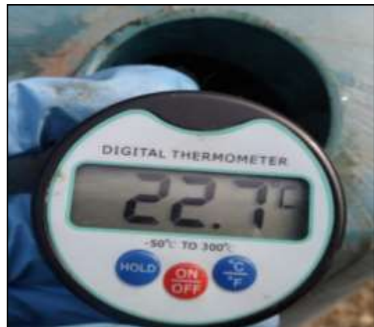
Medición inicial de pH, temperatura, color y olor
