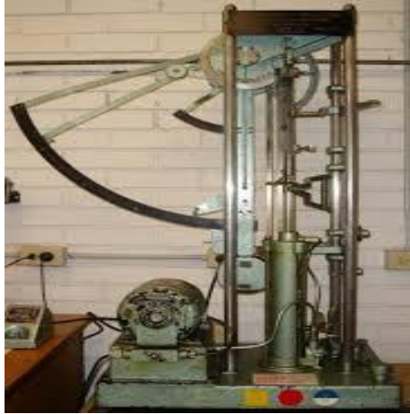
Figura 08: Prueba de Tensión en el equipo Kart Frank
