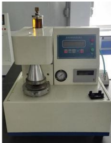
Figura 06: Prueba de explosión
