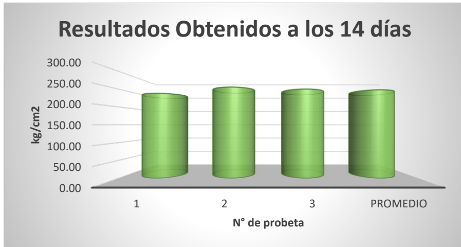
Figura 8. Resistencia a la compresión del pavimento rígido + geoceldas a los 14 días
