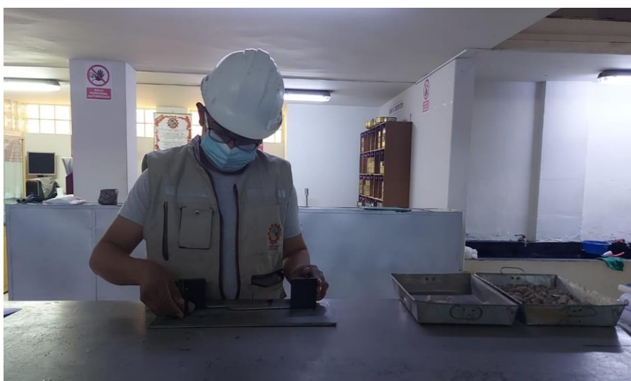
Figura 14: Ensayo de Partículas chatas y Alargadas Fuente: Fotografía propia
