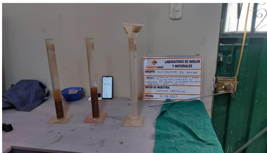
Figura 13: Ensayo de Equivalente de Arena Fuente: Fotografía propia.
