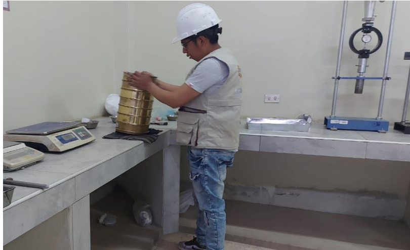
Figura 10: Ensayo de Análisis granulométrico en Laboratorio Fuente: Fotografía propia.
