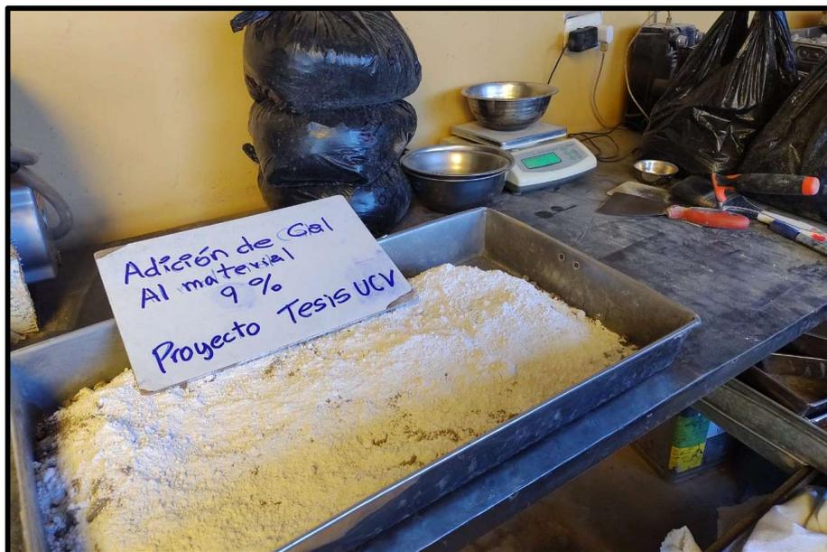
*Figura 33. Adición y mezclado de Cal al 9%*
