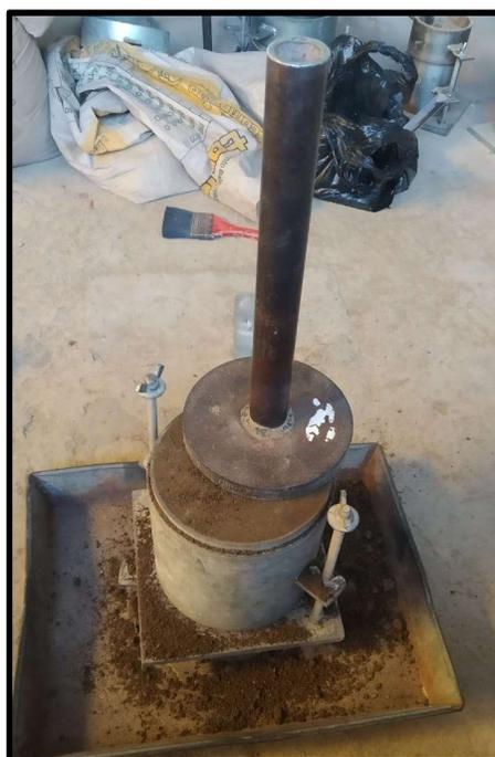
*Figura 25.* Enrasado de moldes, antes de quitar disco espaciador, voltearlos y extraer pesos en cada muestra
