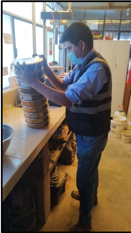
*Figura 16.* Tamizado de muestra para ensayo de Granulometría
