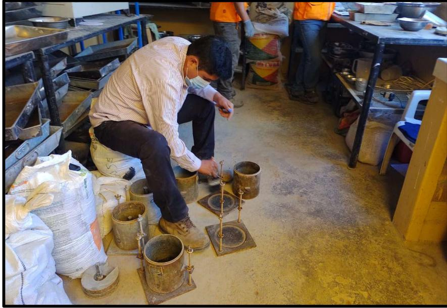
*Figura 34.* Preparación y limpieza de moldes para CBR incorporando Cal Hidratada
