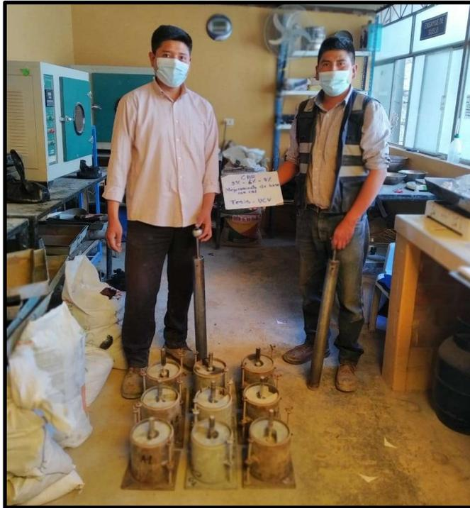
*Figura 36.* Moldes listos y muestras compactadas al 3%, 6% y 9%, para sumergir en poza por 4 días
