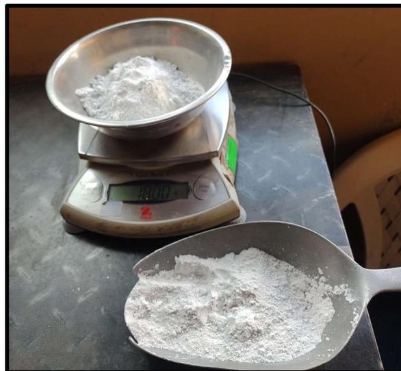
*Figura 29.* Pesando Cal para adicionar 3% (180g)
