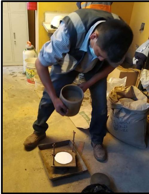
*Figura 35.* Quitando disco espaciador, colocando papel filtro y volteando molde para peso correspondiente
