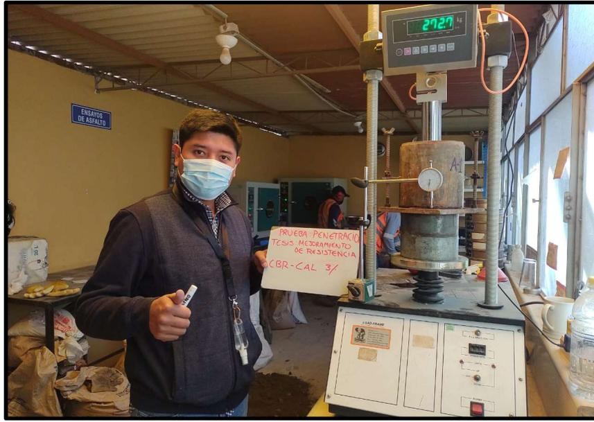
Figura 38. Procedemos con la prueba de penetración en prensa CBR al 3% de Cal
