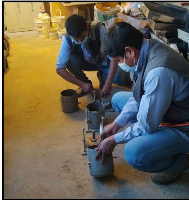
*Figura 23.* Preparación de moldes para CBR (limpieza y Codificación)
