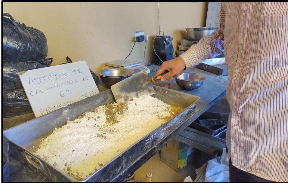
*Figura 32. Adición y mezclado de Cal al 6%*
