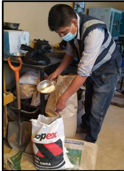
*Figura 28.* Cal Hidratada (Cal de Obra Topex) utilizada para mejora de resistencia
