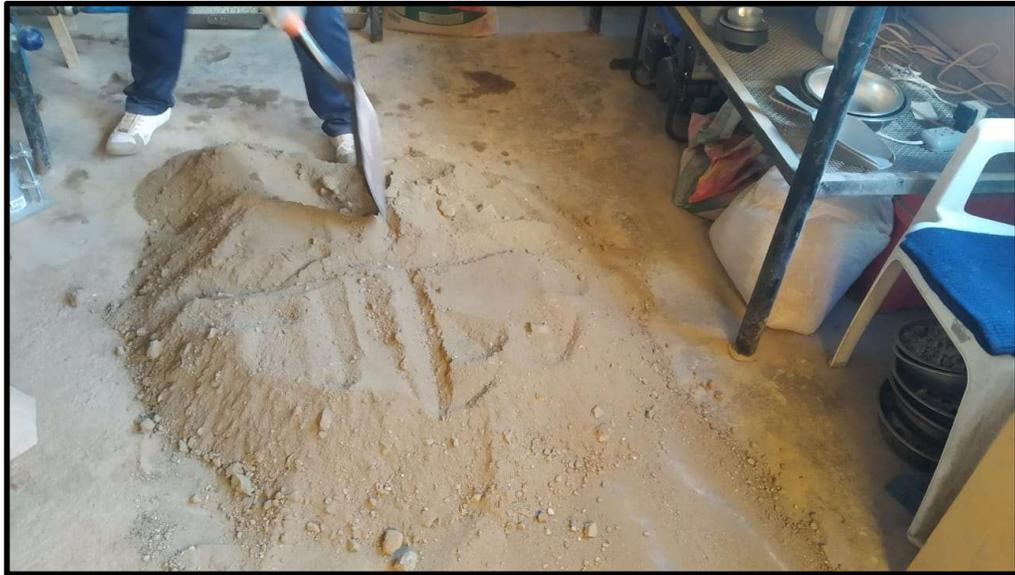
*Figura 15.* Inicio de ensayos con el Cuarteo de la Muestra
