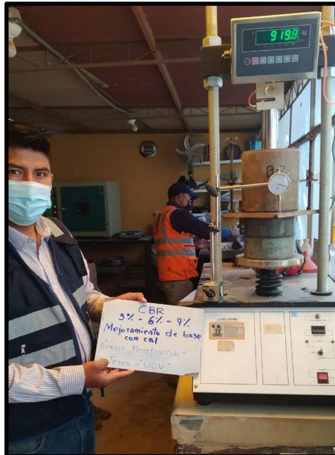
Figura 39. Procedemos con la prueba de penetración en prensa CBR al 6% y 9% de Cal
