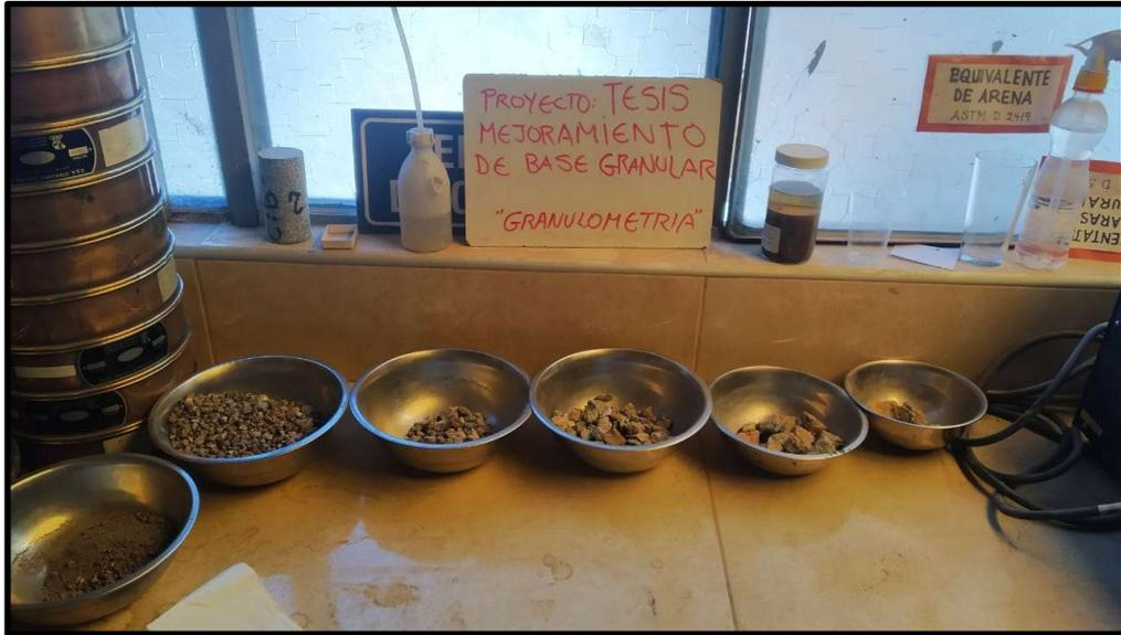
*Figura 17. Tamices de Agregado Grueso listos para pesar*
