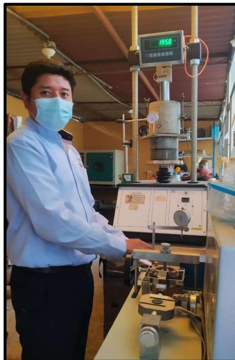
Figura 27. Prueba de Penetración en prensa (velocidad 1.27 mm/s)
