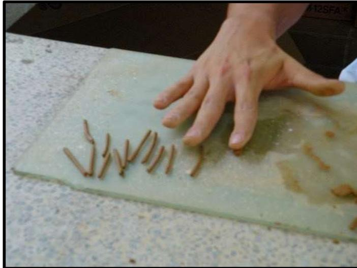
*Figura 8.* Ensayo de plasticidad
