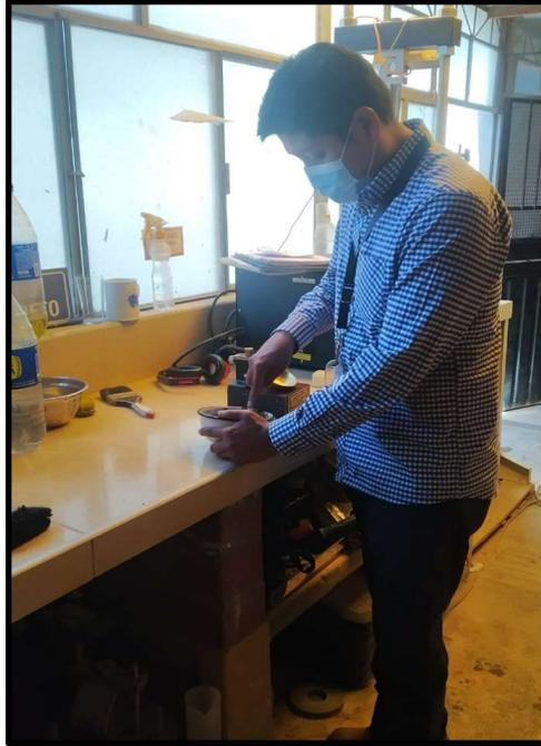
*Figura 18.* Alistando muestra saturada, para Limite Liquido
