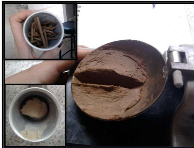
*Figura 7.* Ensayo de Casagrande para determinar el Límite Líquido
