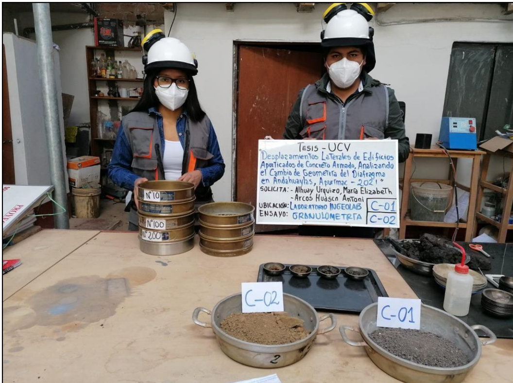
Figura 7: Ensayo de análisis granulométrico por tamizado MTC E 107 – 2000.
