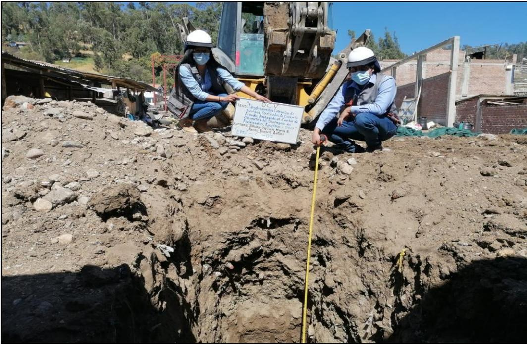
Figura 1: Extracción de material de la calicata (C-01), Av. Los Nogales.
