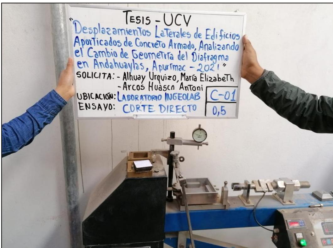
Figura 8: Ensayo de corte directo ASTM D 3080.
