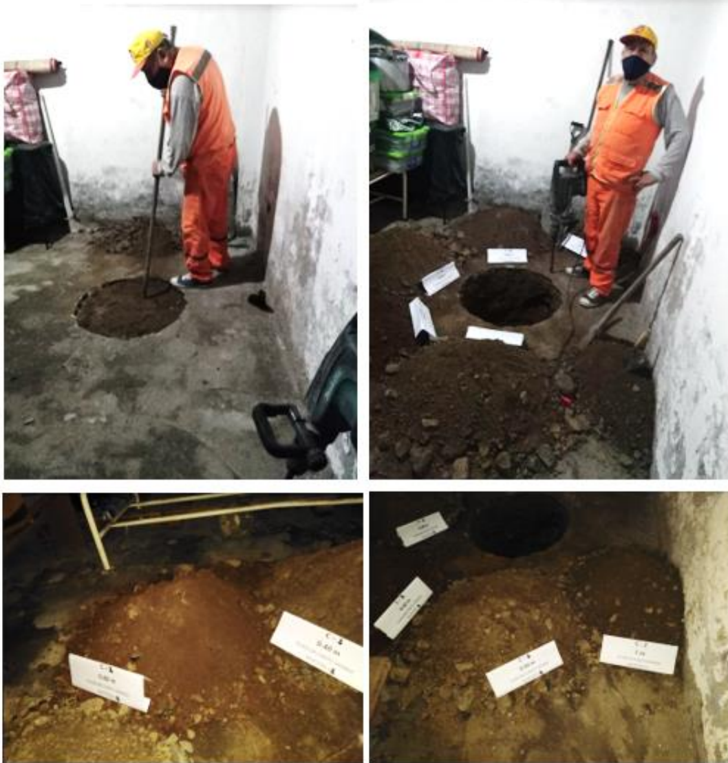
Figura. Se realizó la excavación de la primera muestra de la calicata C-2, con las siguientes indicaciones al señor Felipe Lévano Arias, que separe cada la muestra según la excavación 10cm, 20cm, 30cm, 50cm, 70cm, 1m, 1.5m hasta que llego al suelo gravoso a los 2m. El objetivo era observar las características de cada uno de las muestras según la descripción. Como se puede observar en el panel de fotos el color cambia a medida que se va profundizando. Se concluye que se llegó a la 2m por estar la vivienda ubicada cerca al cerro haciendo de ello un suelo granular de gravas.
