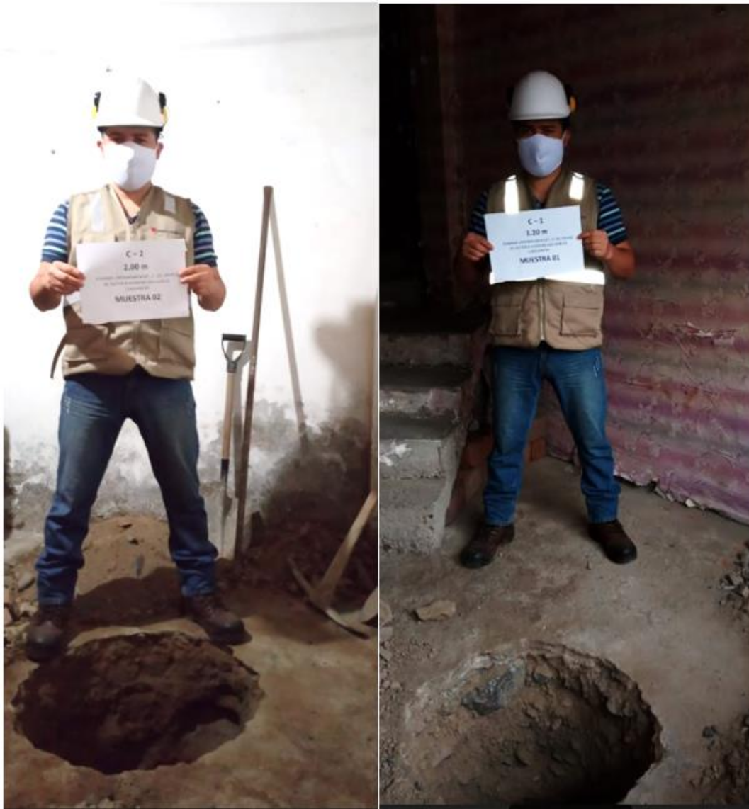
Figura. La evidencia que se realizó las dos calicatas para el análisis de estudio del ensayo de suelo, con una distancia de calicata a calicata de 10 m donde la muestra C-1 se realizó con una profundidad de 1.20 m por llegar a un la parte de grava y suelo gravosos, en la muestra C-2 se realizó una profundidad de 2m llegando así a la parte de grava y suelo gravosos.
