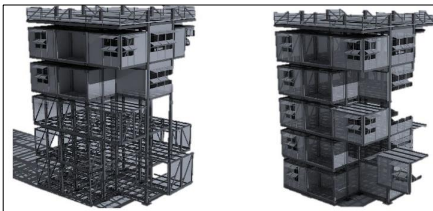
Figura 1. Diseño de un sistema de construcción modular en acero para vivienda social en altura Fuente: Romero y Rojas, 2017
