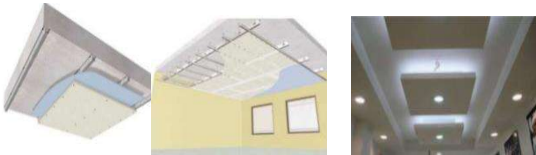
Figura 157: proceso de instalación de falso cielo raso en Drywal
