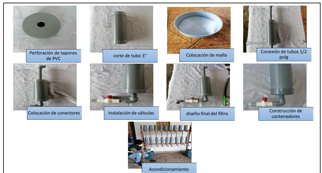
Figura 2. Proceso constructivo de filtro de agua.
