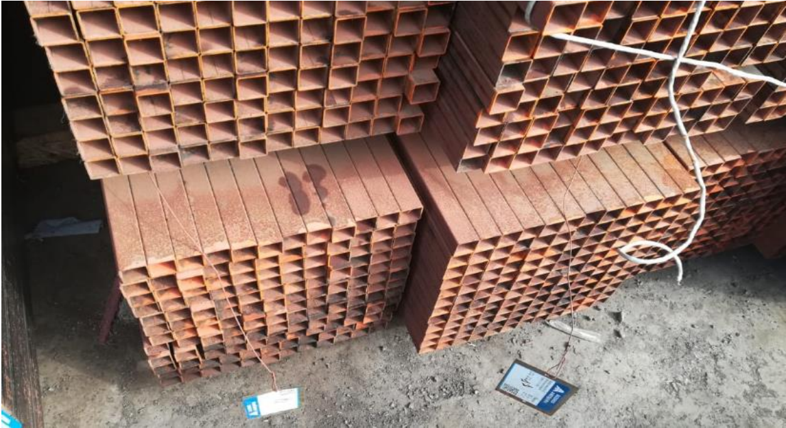
Figura. 19 Tubos LAF con Oxidación Crítica
