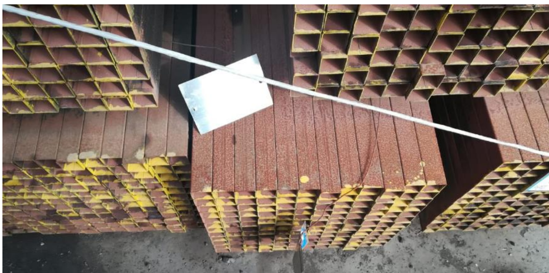
Figura. 18 Tubos LAF con Oxidación Crítica
