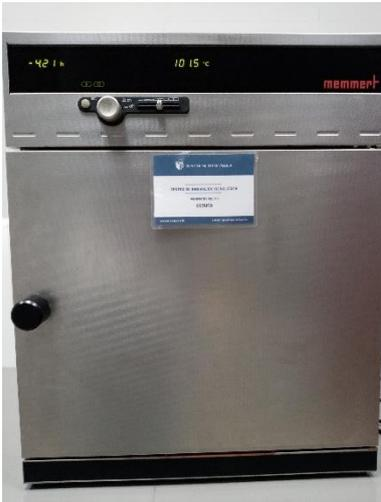
Fig. 14. Estufa empleada para determinar la humedad del loctao.
