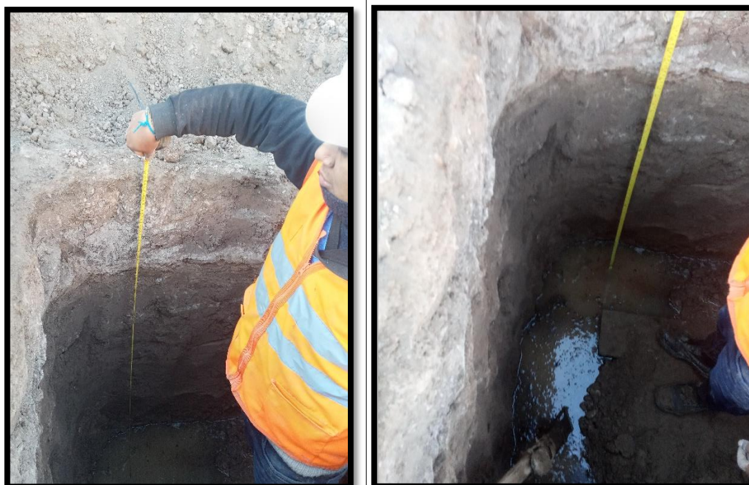
Figura 28 Ubicación del nivel freático a 1.50m de profundidad.
