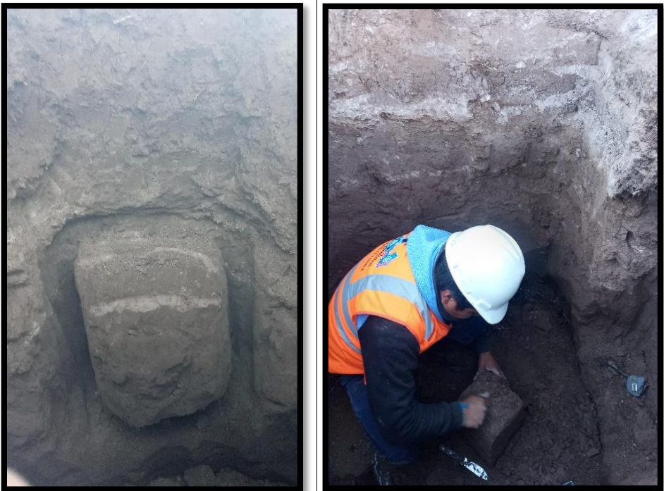
Figura 29 Extracción de muestra inalterada de 20cm x 20cm x 20xm.
