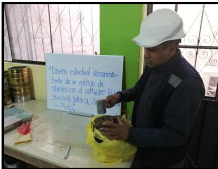
Figura 31 Extracción de la muestra inalterada en los moldes.
