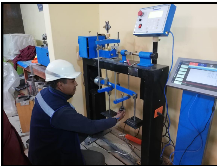
Figura 33 Colocado de moldes al equipo de corte directo.
