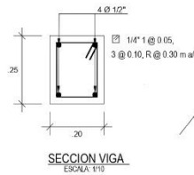
DETALLE DE LA VIGA SALPICADOR ESCALA: 1/10
