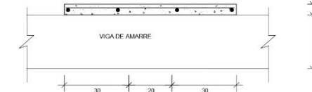
DETALLE DE LA VIGA SALPICADOR ESCALA: 1/10
