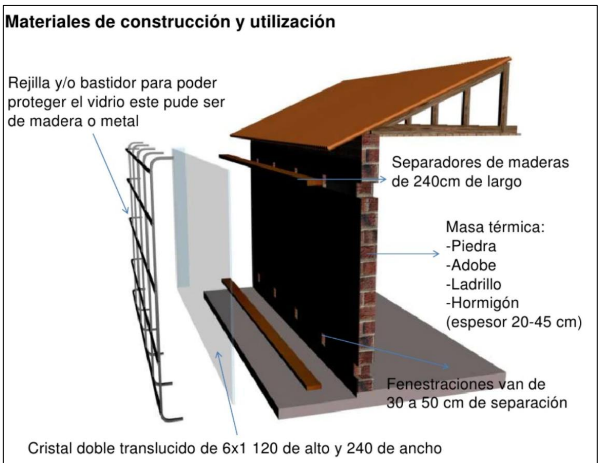
Figura 40 Descripción de muro Trombe
