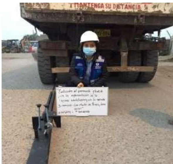
**Figura N°05:** Ensayo de deflectometría con la Viga Benkelman
