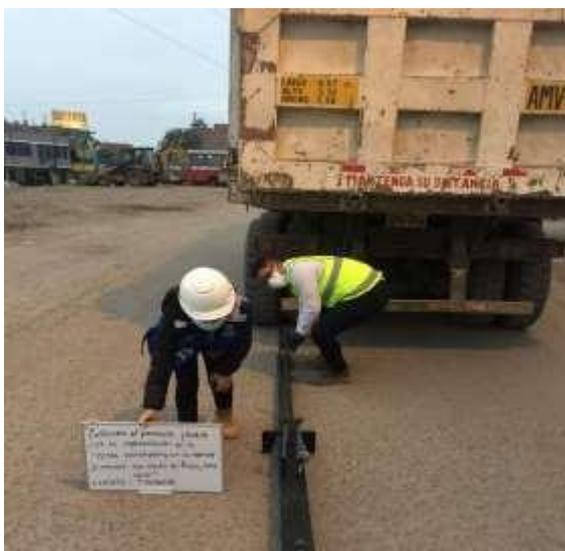
**Figura N° 04:** Ensayo de deflectometría
