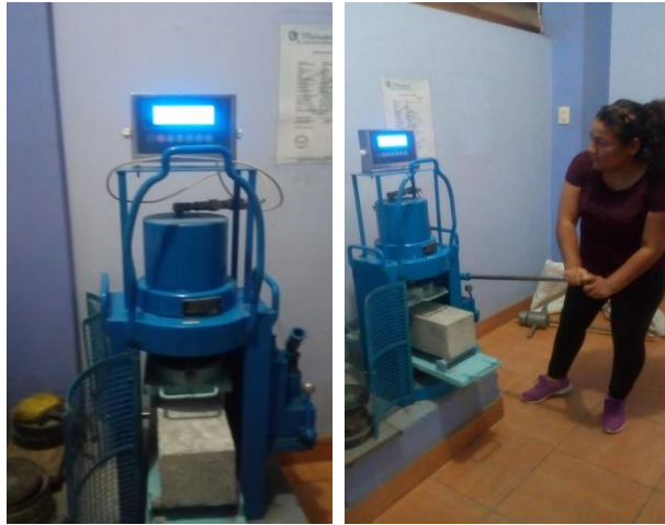
Figura 19. Ensayo de resistencia a la flexión en concreto patrón f'c=210 kg/cm 2 .
