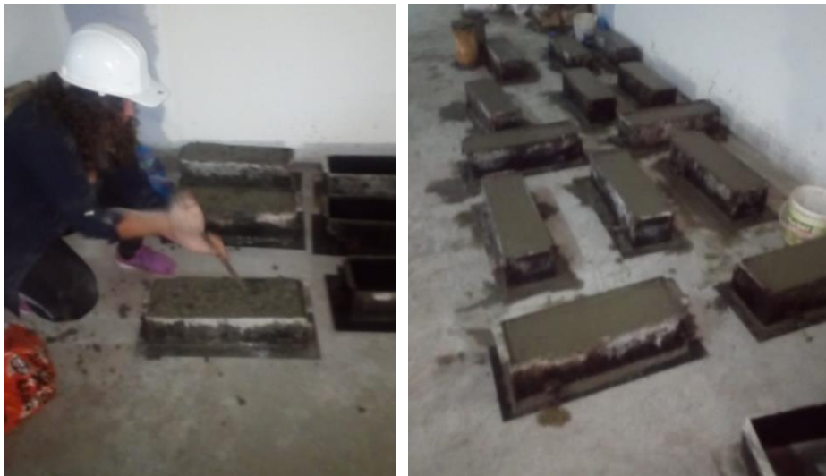
Figura 14. Elaboración de vigas prismáticas del concreto f'c=210\text{ kg/cm}^2 + 3% de grapas de alambre galvanizado.
