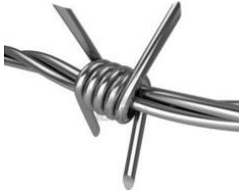
Figura 11. Púa que se extraerá de Alambre galvanizado usado para cercos de seguridad y que será adicionado al concreto patrón en 1% y 3%.
