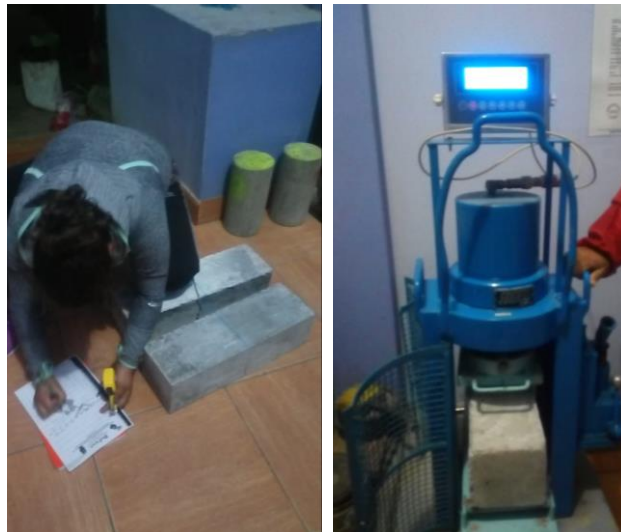
Figura 20. Ensayo de resistencia a la flexión en concreto patrón f'c=210 kg/cm 2 a los 28 días.
