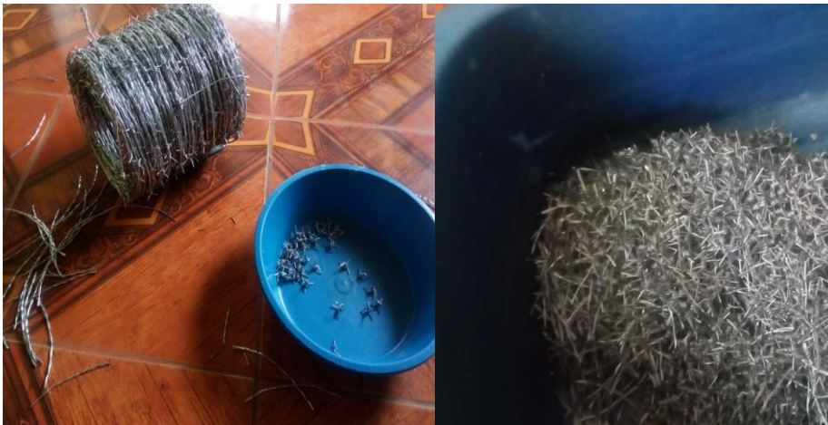
Figura 12. Extracción de fibra metálica tipo púas .
