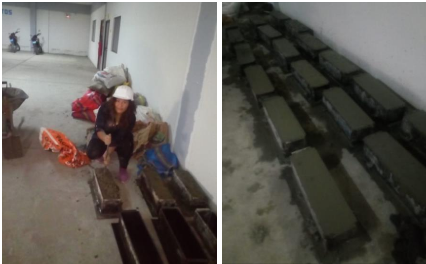
Figura 13. Elaboración de vigas prismáticas del concreto patrón.
