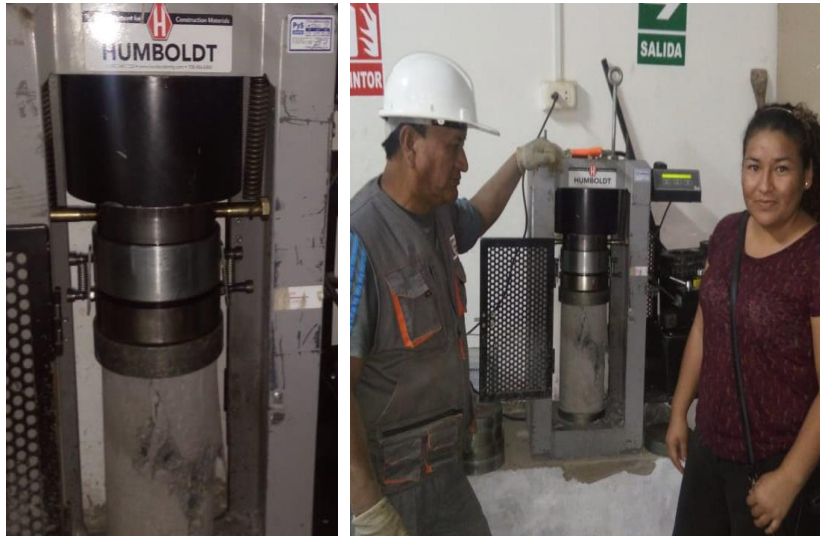
Figura 17. Ensayo de resistencia a la compresión en concreto patrón f'_c=210 \text{ kg/cm}^2
