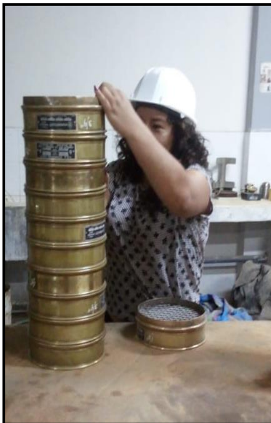
Figura 5. Proceso de tamizado Agregado Fino.
