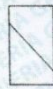
Tipo 4 Fractura diagonal sin fisuras a través de los extremos, golpeado suavemente con un martillo para distinguirlo del Tipo 1
