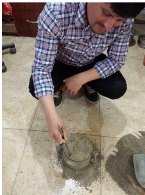
Compactación del agregado fino.
