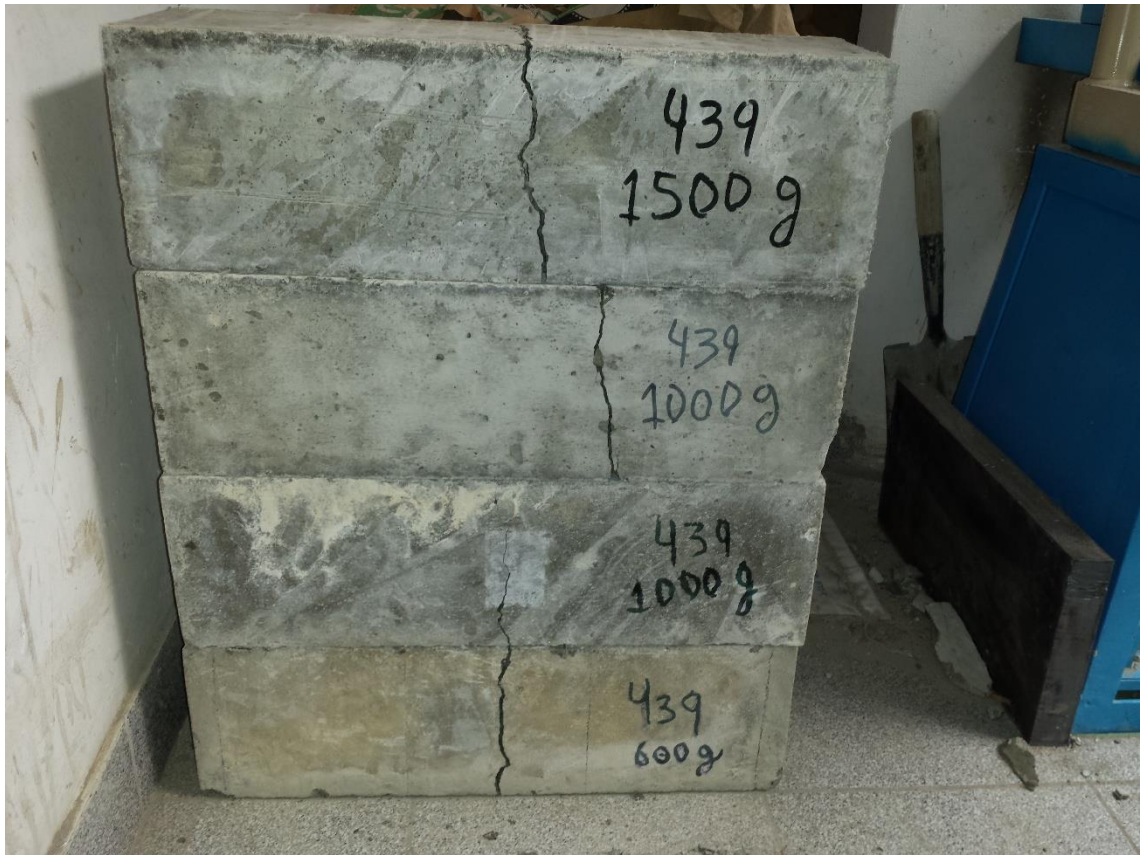
Vigas pasadas por la máquina de rotura por flexión, para cada variación de fibra de polipropileno.
