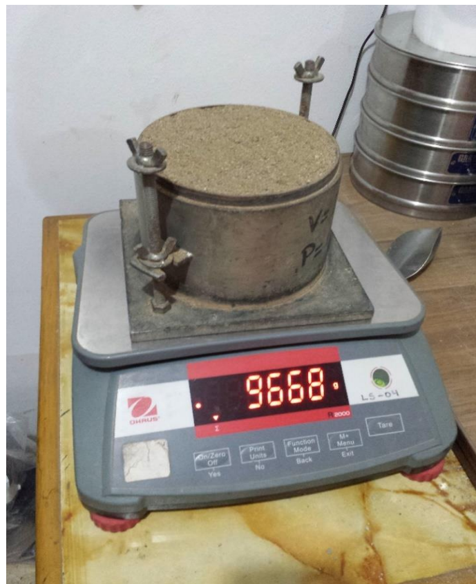
Peso del agregado fino compactado y enrazado en el molde
