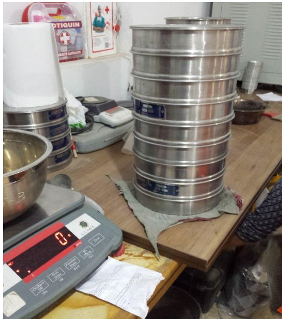
Tamices para realizar la granulometría.
