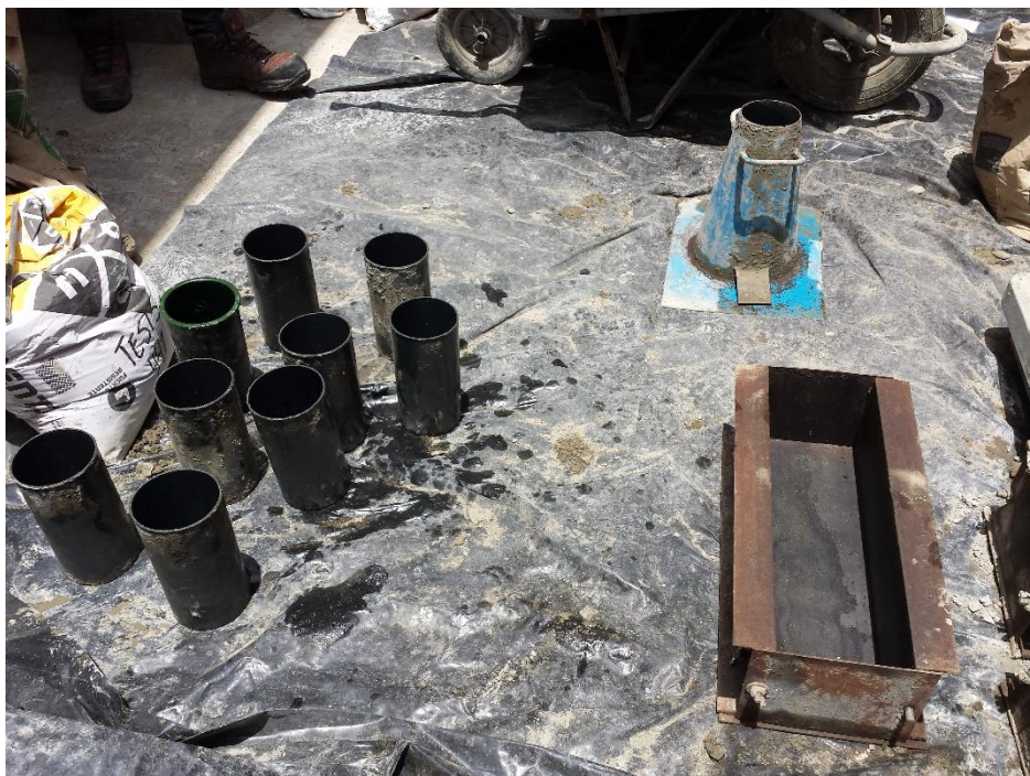
Preparación de moldes de probetas, vigas y cono de Abrams, listos para el vaciado de la mezcla
