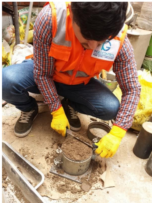
Realizando el enrazado en el molde para el CBR
