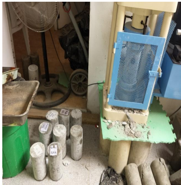
Colocación de testigo cilíndrico para la resistencia a la compresión.
