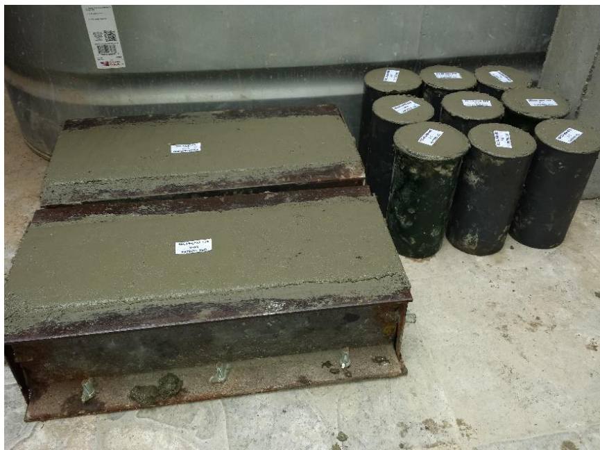
Llenado de mezcla en probetas y vigas.
