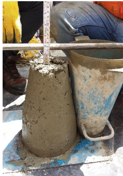
Realizando la medida del asentamiento (slump).
