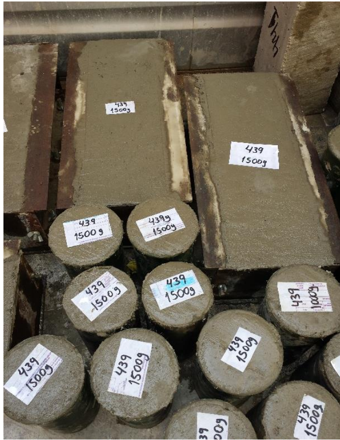
Testigos con incorporación de fibra de polipropileno de 1500 g.
