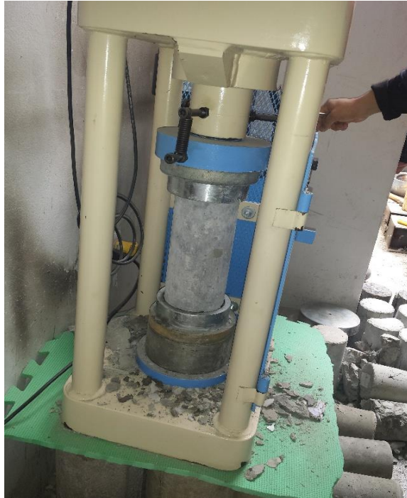
Observando la falla que ocurre mediante la rotura
