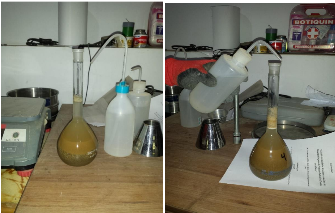
Peso específico aparente y la absorción de la muestra fina.
