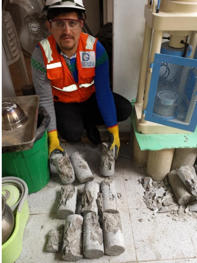
Testigos pasadas por la máquina de rotura
