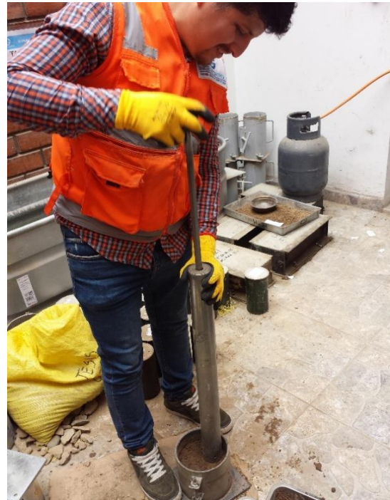
Utilizando el pistón manual para el CBR
