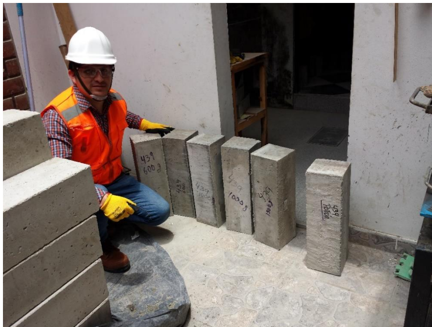
Vigas para ser ensayadas a resistencia a la flexión de concreto
