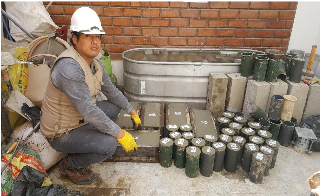
Testigos con incorporación de fibra de polipropileno de 600g, 1000g y 1500g.
