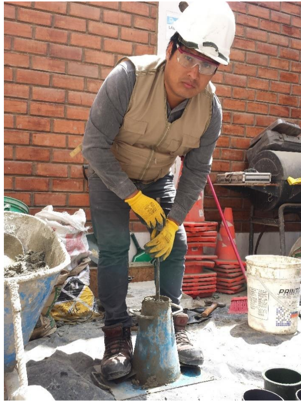
Realizando el compactado con la varilla con una repetición de 25 golpes por capa.
