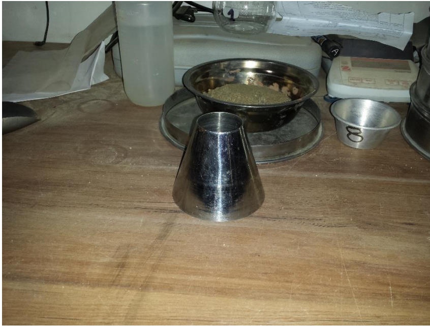
Secado superficial para conocer el peso específico saturado
