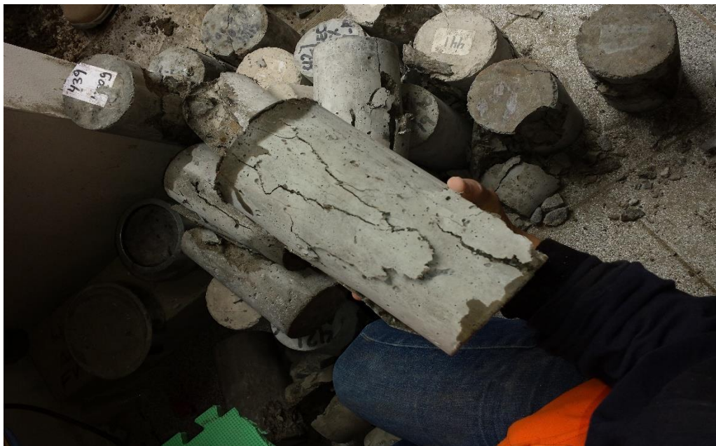
Observando tipo de falla de la testigo ensayada
