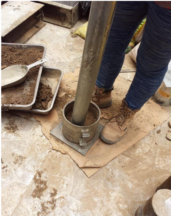
Utilizando el pistón manual para el CBR
