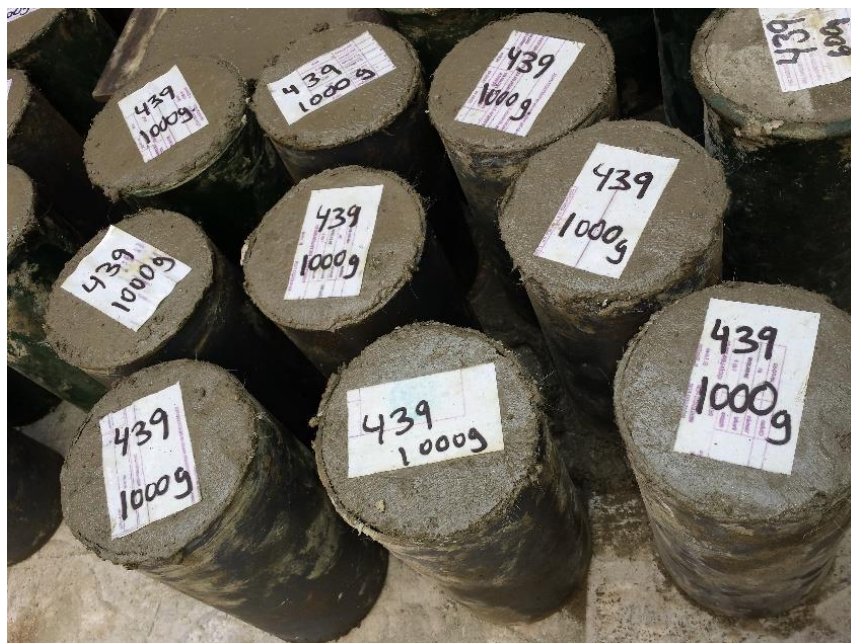
Probetas incorporadas con fibra de polipropileno de 1000 g.
