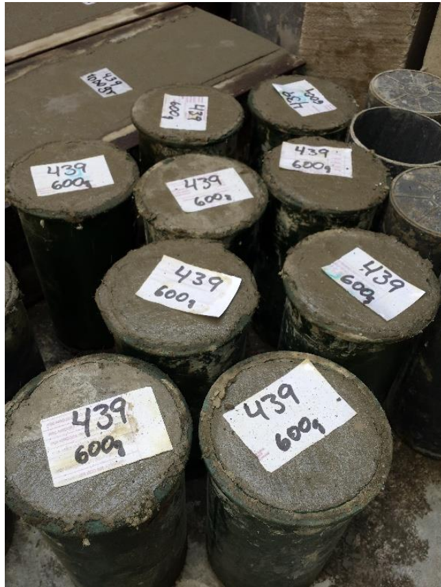
Probetas incorporadas con fibra de polipropileno de 600 g.
