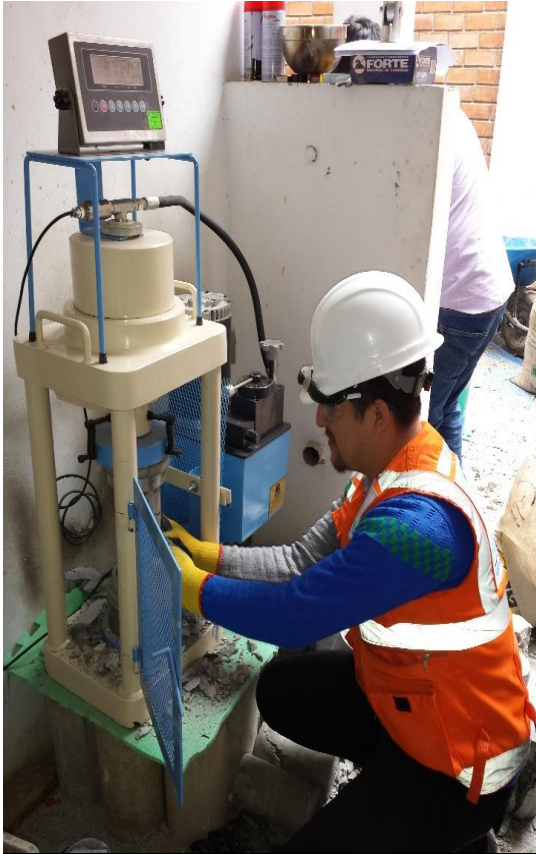
Retirando el testigo de la máquina de rotura
