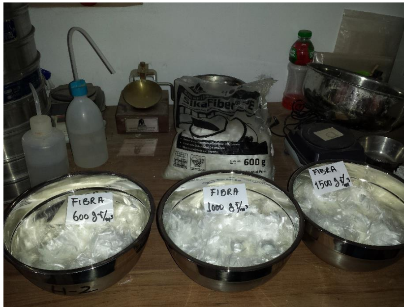
Pesos de la fibra de polipropileno 600g, 1000g y 1500 g.
