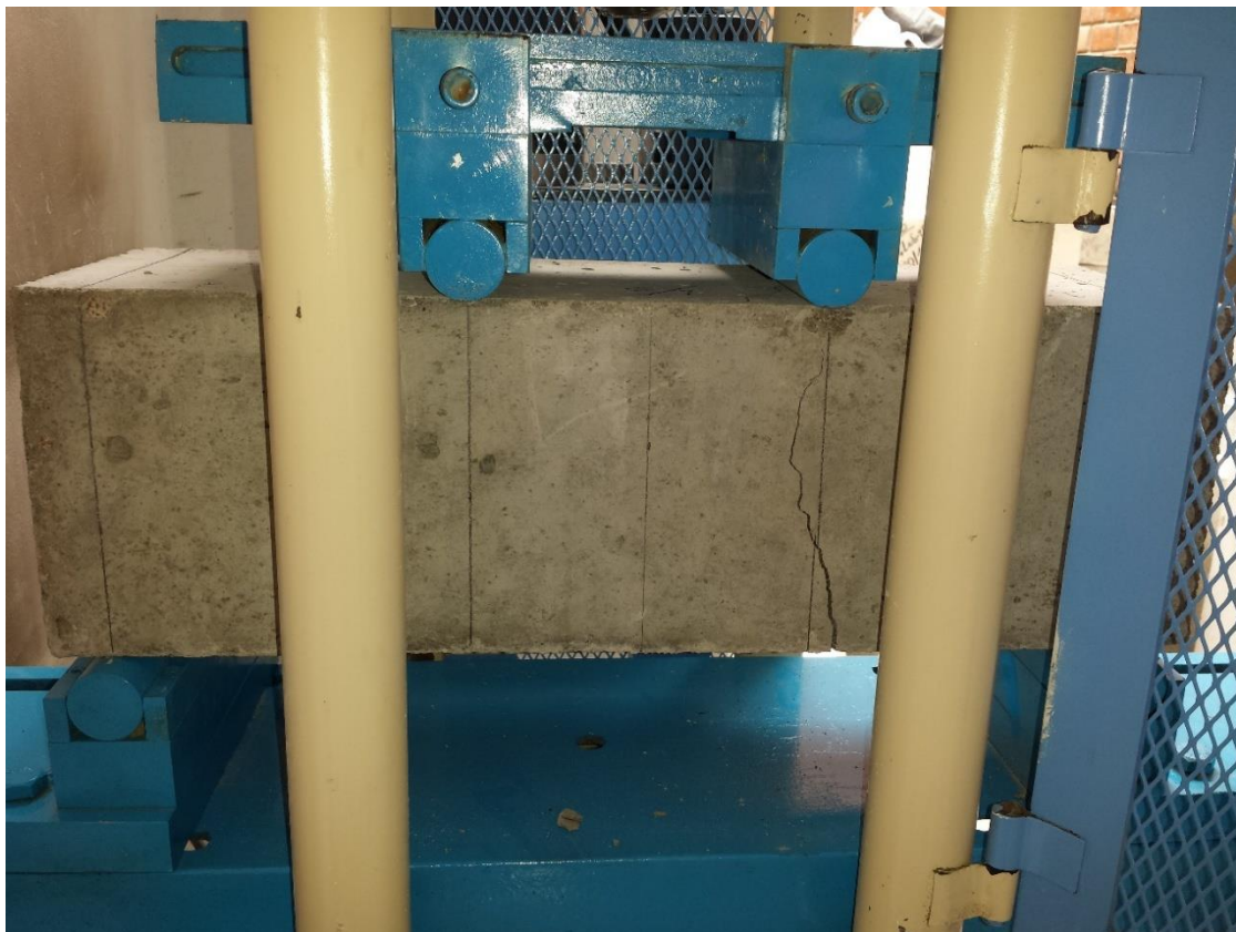
Viga colocada en la máquina para la rotura de viga por flexión
