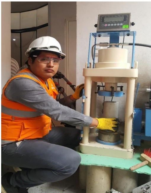
Colocación de testigo cilíndrico para la resistencia a la compresión.
