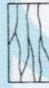
Tipo 3 Fisuras verticales encolomadas a través de ambos extremos, conos no bien formados
