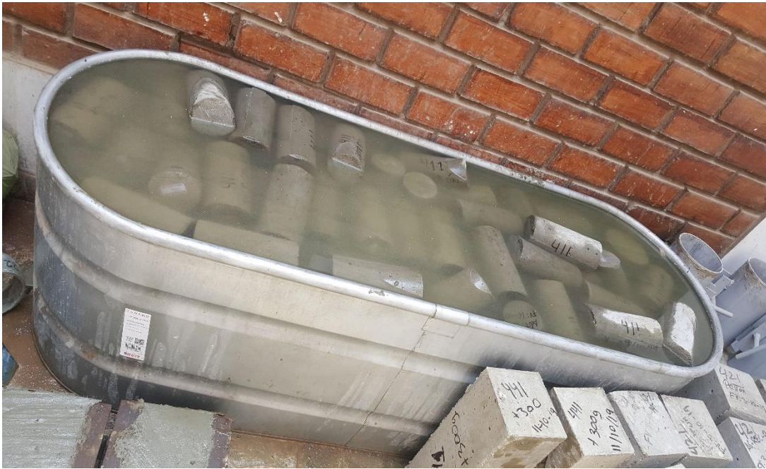
Curado de testigos en posa de agua
