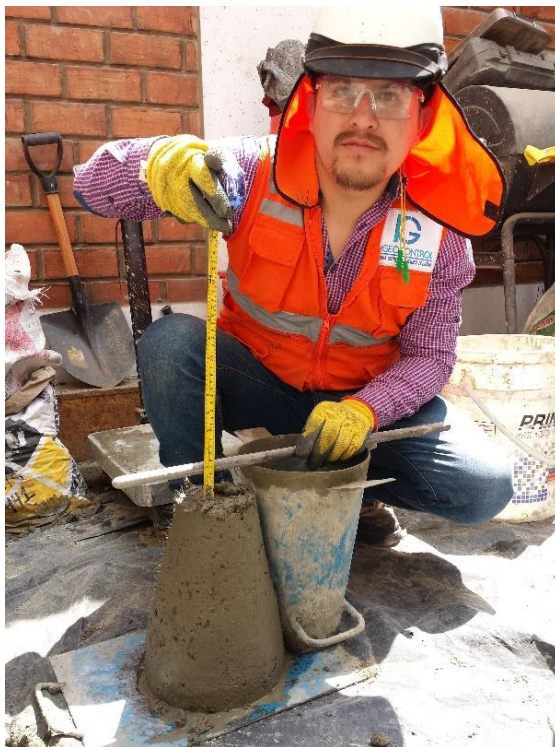
Realizando la medida del asentamiento (slump).
