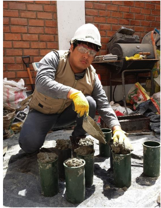
Llenado de probetas y realizando la compactación con la varilla lisa.
