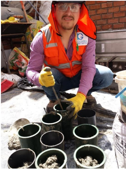
Llenado de probetas y realizando la compactación con la varilla lisa.
