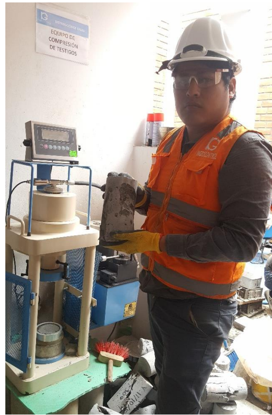
Retirando el testigo de la máquina de rotura
