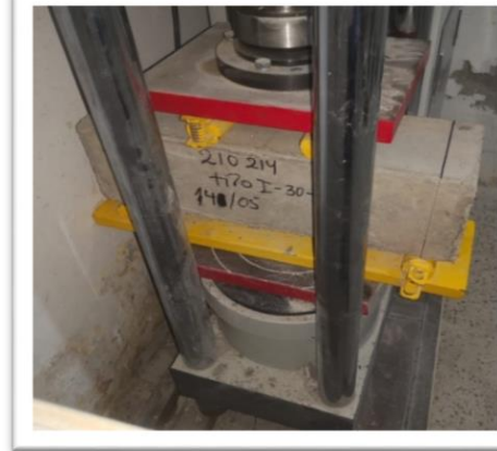
Foto 36: Ensayo de Viga de concreto Tipo I con Adición de 30 kg de Fibra de Acero
