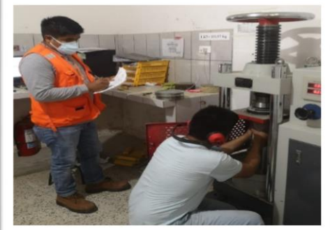
Foto 27: Ensayo de Probetas Cilíndricas a compresión en Prensa ( Evidencia de Toma de Datos)
