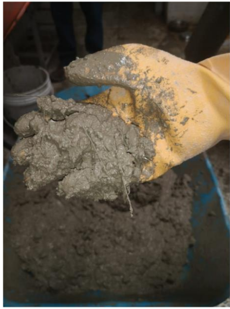
Foto 13: concreto con Fibra de Acero
