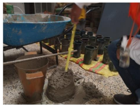
Foto 15: Medición de Slump del concreto Patrón
