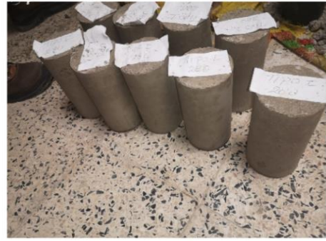
Foto 22: Probetas Cilíndricas fuera del recipiente con Etiqueta Temporal
