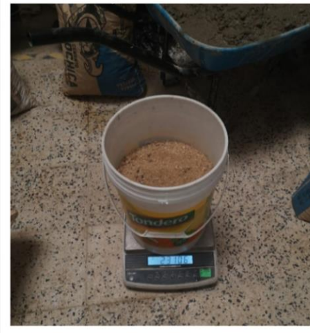
Foto 8: Peso del Agregado Fino Para Mezcla de Concreto
