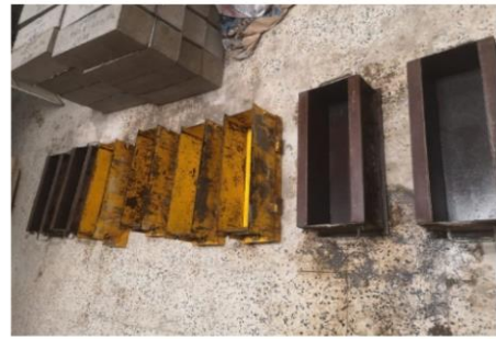
Foto 24: Moldes para Elaboración de Vigas, Al Lado Vigas desmoldadas
