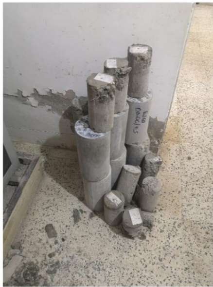
Foto 31: Probetas Cilíndricas después de ser ensayadas
