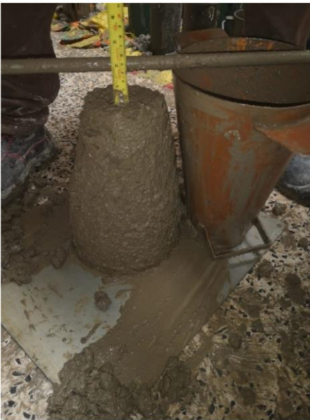
Foto 19: Medición del perdida de Asentamiento del concreto, medido cada 30 minutos
