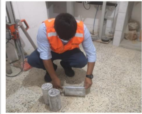
Foto 25: Toma de dimensiones de Probetas cilíndricas
