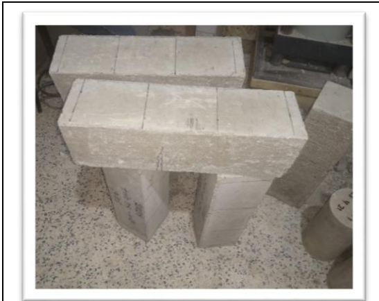
Foto 41: Evidencia de Falla en Vigas, producto de la Aplicación de Cargas (Ensayo a Flexión)
