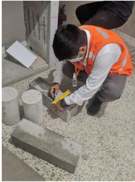
Foto 33: Marcado de Vigas Para ensayo de Resistencia a la flexión del concreto - marcado del tercio central, tramos de 15 cm
