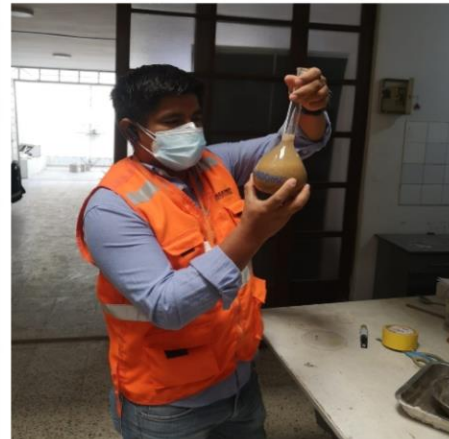
Foto 6: Ensayo de Peso Específico del Agregado Fino
