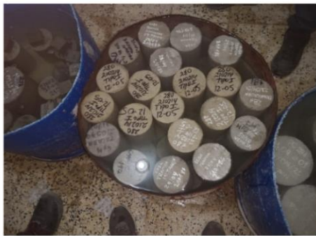
Foto 23: Curado de probetas Cilíndricas
