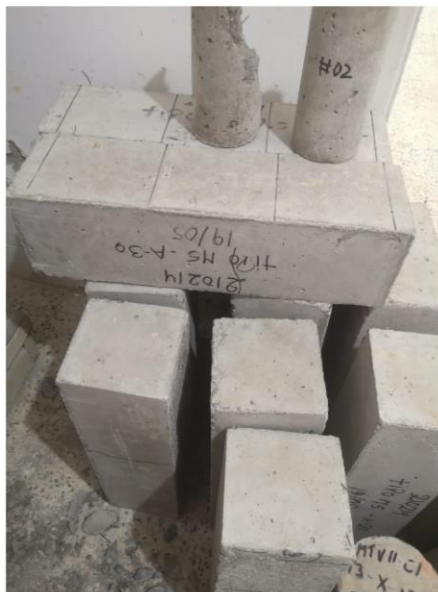
Foto 39: Evidencia de Vigas Ensayadas con Falla en el tercio Central
