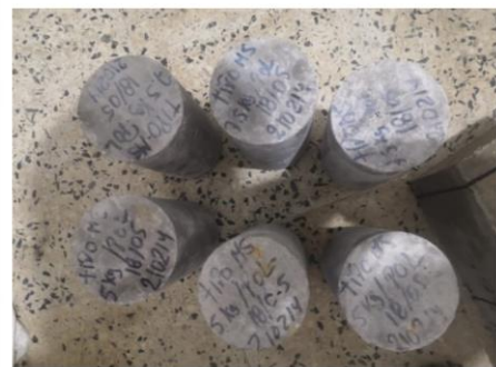
Foto 28: Probetas Cilíndricas para ensayos a compresión de concretos Tipo MS con 5 y 7.5 kg de adición de Fibra de Polipropileno
