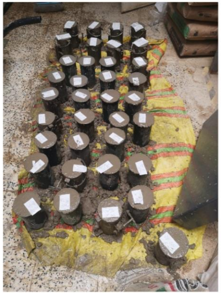
Foto 20: Testigos Cilíndricos Elaborados para ensayo de resistencia a la compresión del concreto (dimensiones de h=20 cm y d=10 cm)
