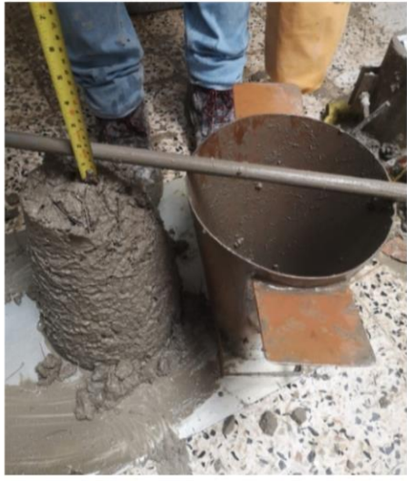
Foto 17: Medición del Asentamiento del Concreto fibro-reforzado después de 60 min. de culminado el mezclado
