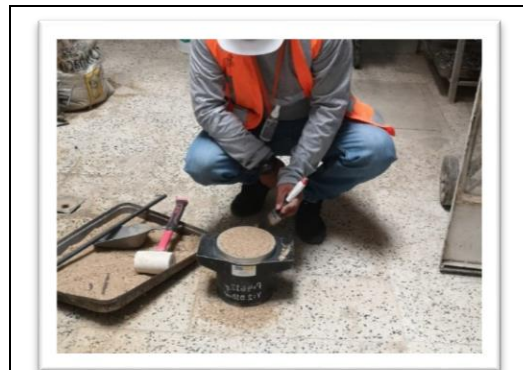
Foto 2: Peso unitario Compactado (Varillado) del Agregado grueso
