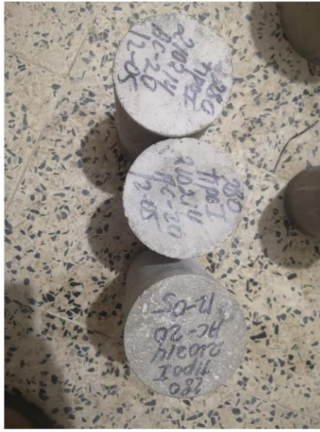
Foto 29: Probetas Cilíndricas para ensayos a Compresión del Concreto del concreto Patrón Tipo I - Evidencia de Etiquetado
