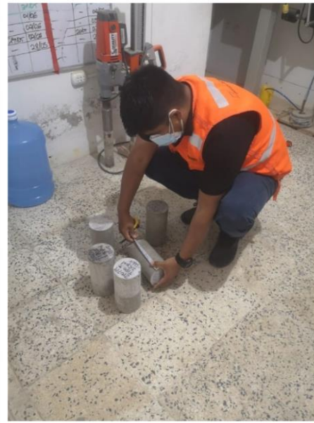
Foto 26: Toma de dimensiones de Probetas Cilíndricas
