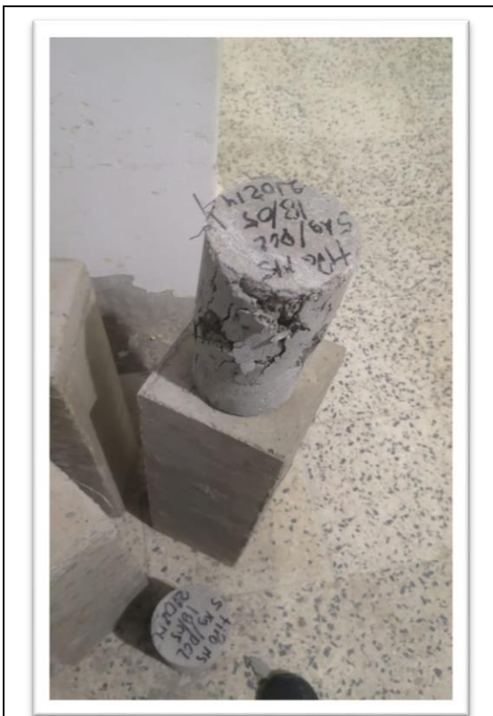
Foto 43: Espécimen después de ensayo
