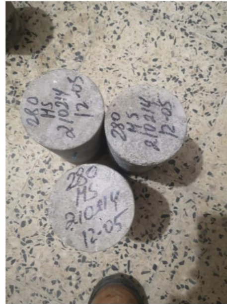
Foto 30: Probetas Cilíndricas para ensayos a Compresión del Concreto del concreto Patrón MS con su respectiva identificación
