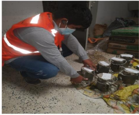
Foto 21: Desmoldado de Probetas Cilíndricas
