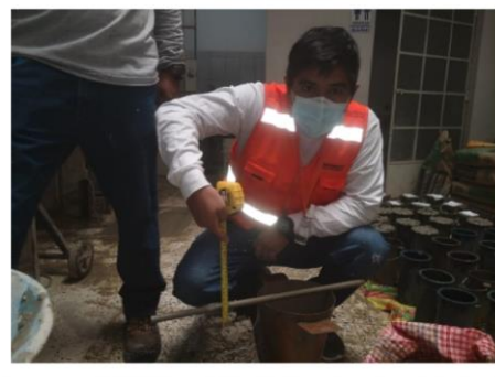
Foto 16: Medición del Asentamiento de Concreto Fibroreforzado
