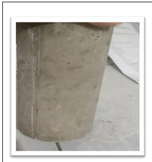
Foto 44: Espécimen 03 sin evidencia de Falla - Probeta después de ensayada de concreto Tipo I con adición de 5 Kg. de Fibra de Polipropileno
