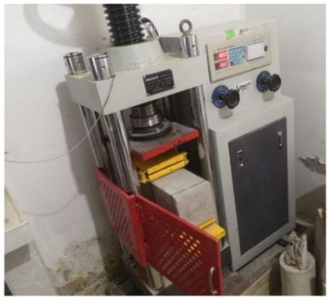
Foto 35: Evidencia de Ensayo de Resistencia a la flexión del concreto
