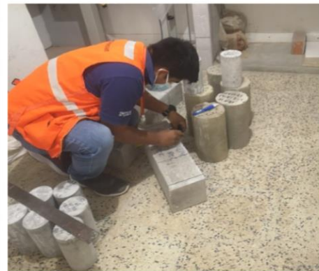
Foto 32: Marcado de Vigas para ensayos a Flexión del concreto
