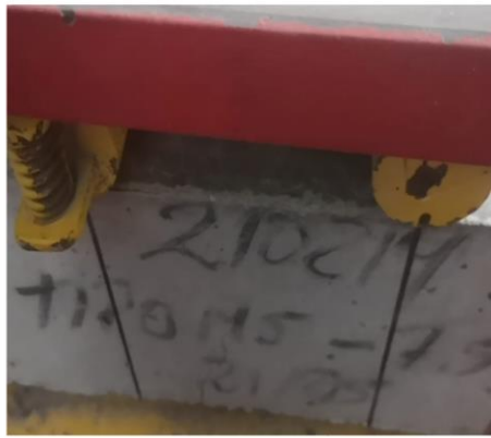
Foto 37: Ensayo de Viga de Concreto MS con 7.5 Kg. de Fibra de Polipropileno
