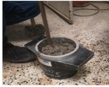
Foto 14: Ensayo de Peso unitario Varillado del Concreto
