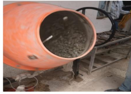
Foto 10: Mezclado de Concreto - comprobación de Diseño
