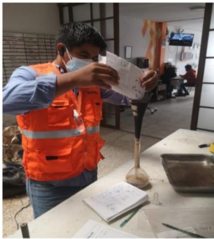
Foto 7: Llenado de recipiente para Ensayo de Peso Específico del Agregado Fino
