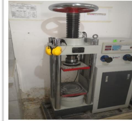
Foto 34: Prensa para ensayos de compresión y flexión del concreto
