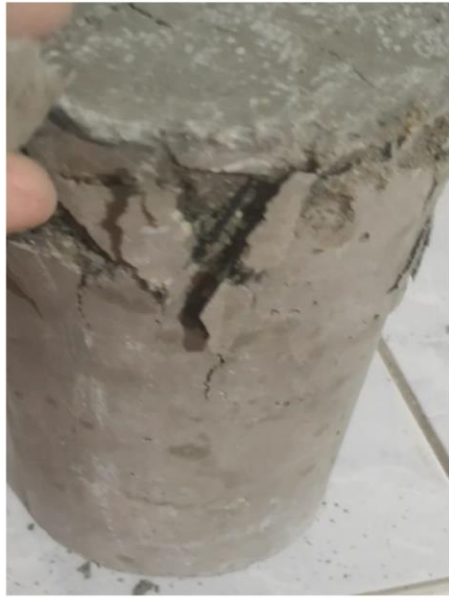
Foto 45: Espécimen después del ensayo a 28 días - Concreto Tipo I + 5 kg. de Fibra de polipropileno
