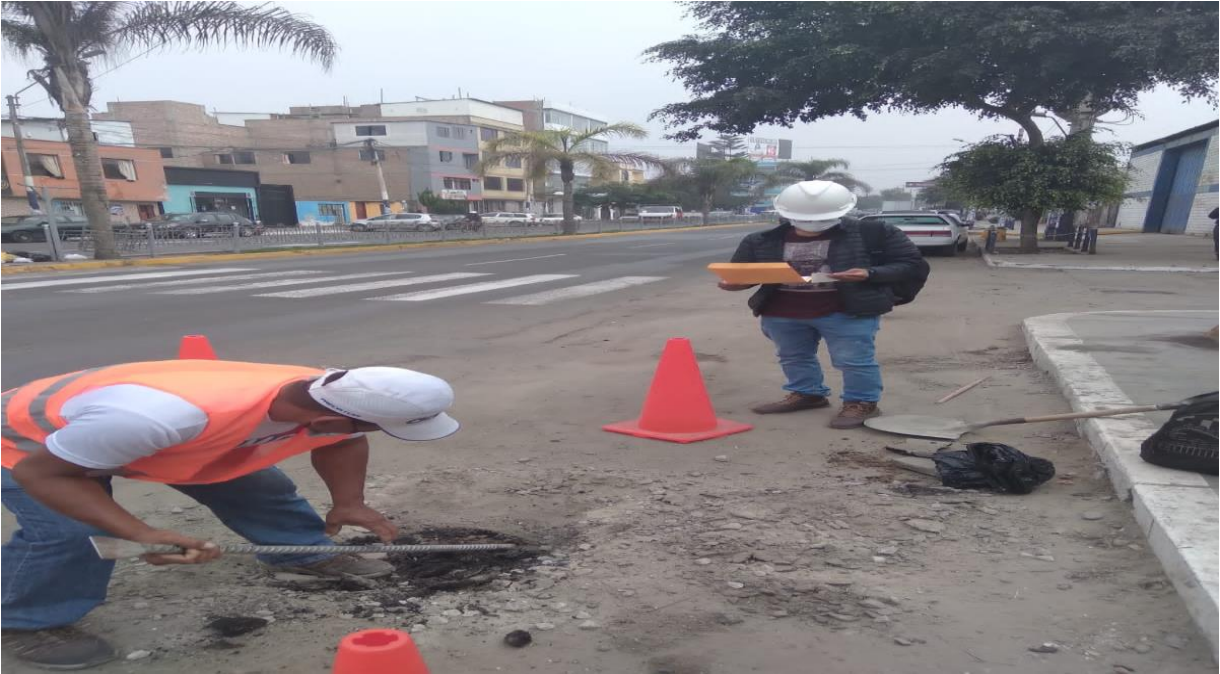
Obteniendo la muestra de suelo de la primera calicata
