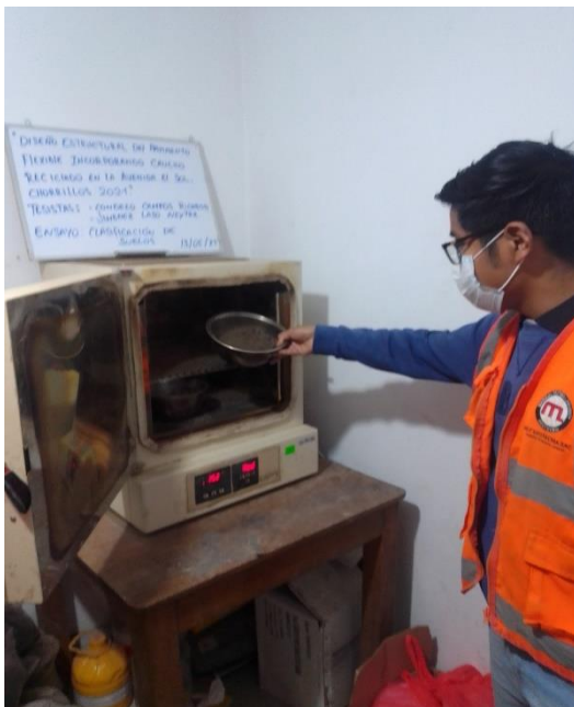
Realizando los limites líquidos y plásticos
