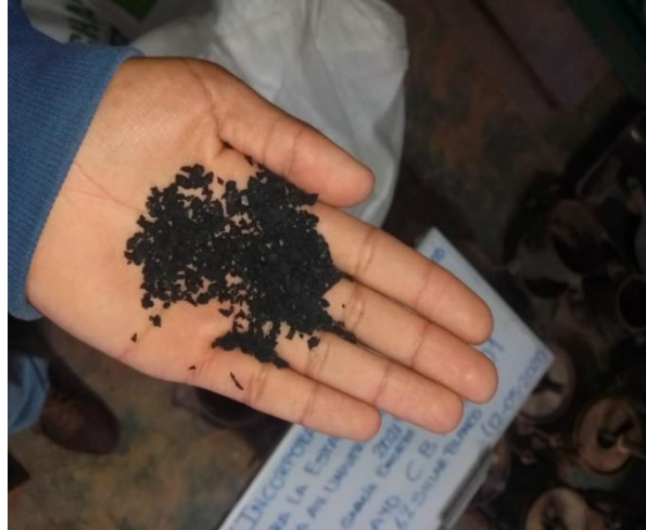
Figura 26. obtención del caucho reciclado
