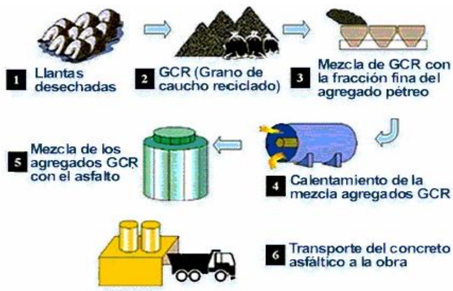
Figura 4. Proceso de obtención del asfalto con caucho reciclado.
