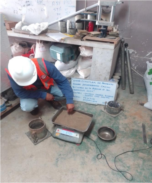
Realizando el Proctor modificado de las muestras
