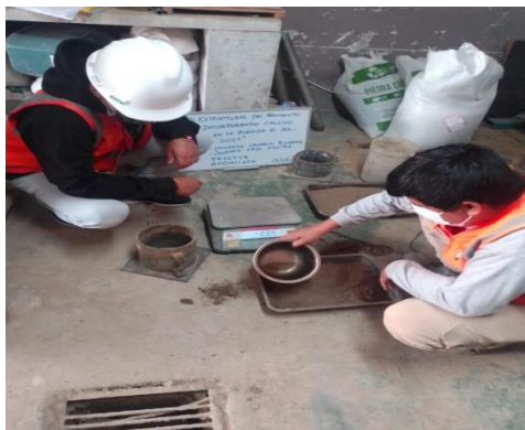
Figura 12. Proctor modificado primera muestra de suelo.
