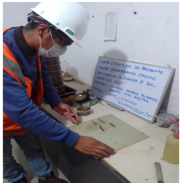
Realizando los limites líquidos y plásticos
