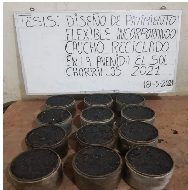
Figura 23. probetas obtenidas del diseño
