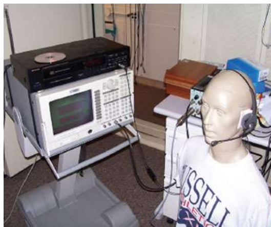
FIGURA 4.32. PROCESO DE MEDICIÓN DE DB EN LOS AURICULARES
