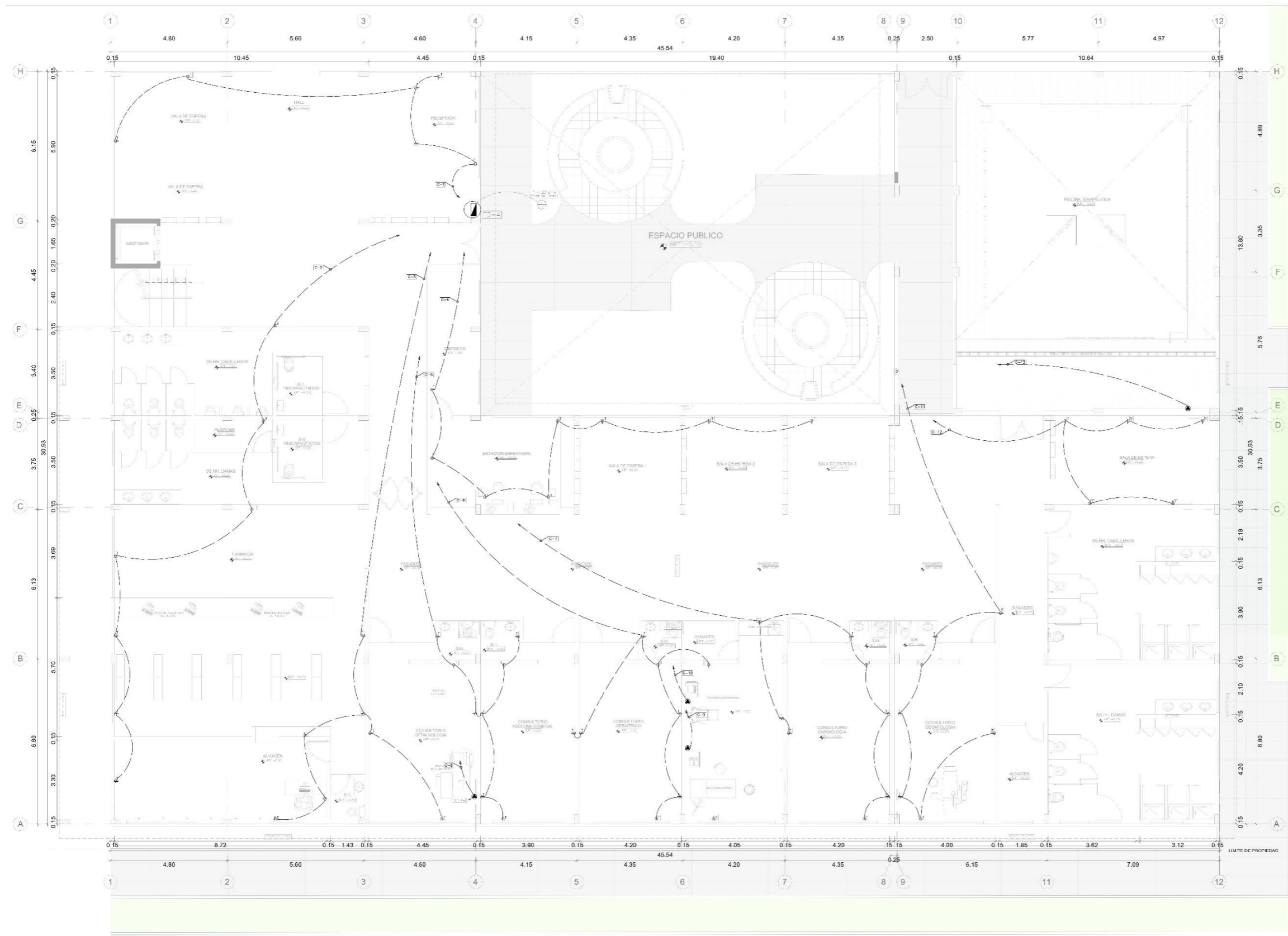
PLANO DE RED DE TOMACORRIENTE 1ER NIVEL 1/50
