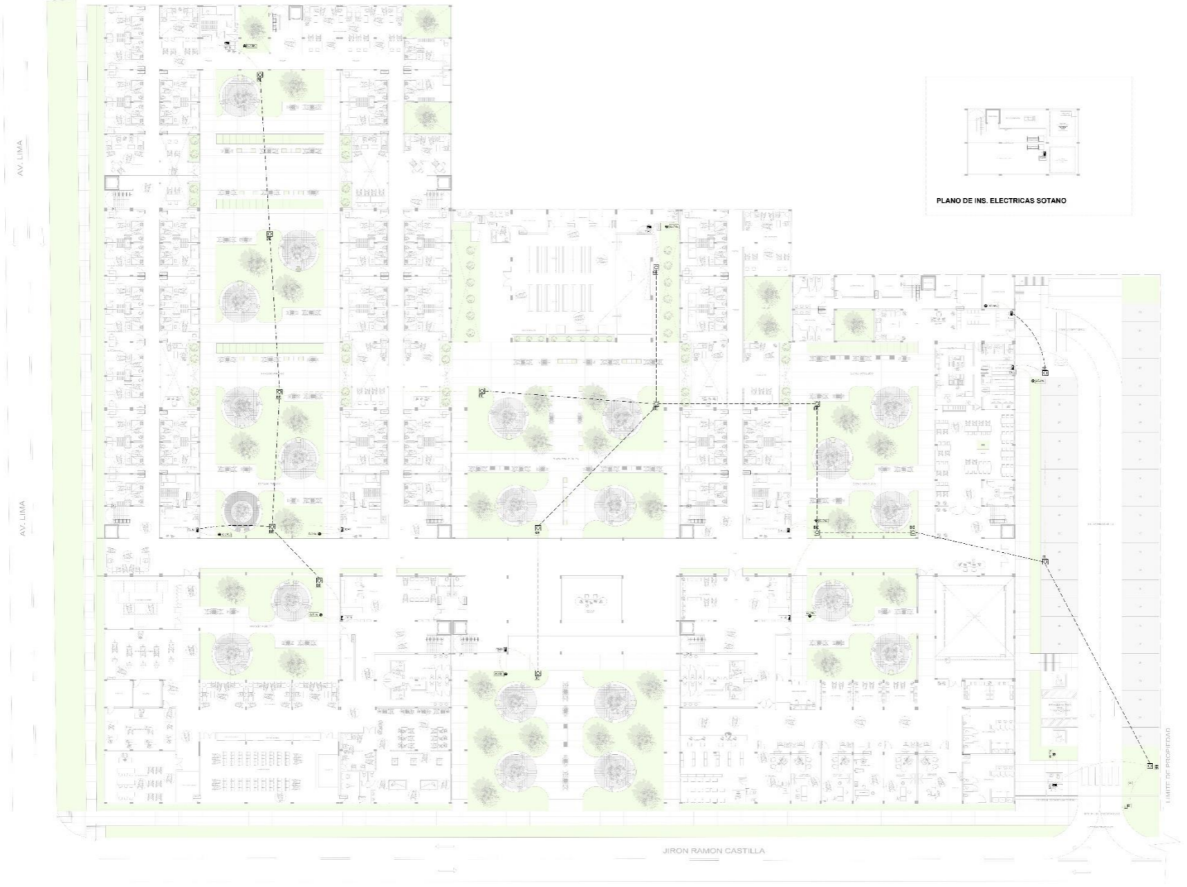
PLANO DE INSTALACIONES ELECTRICAS PRIMER NIVEL 1/200
