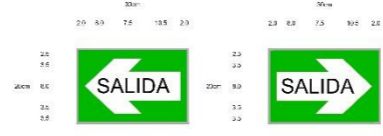
SEÑAL DE: RUTA DE EVACUACION NOTA: Las señas deben ser colocadas a 1.50m. del piso.
