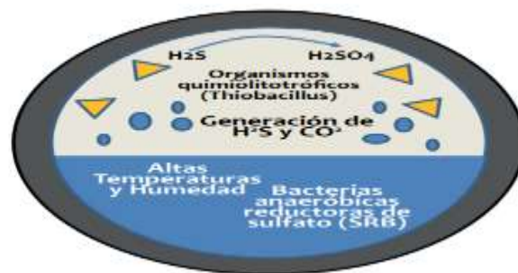
Figura 2. Esquema del transcurso de oxidación del concreto inducido microbiológicamente en un conducto o drenaje de agua residual (Turris, 2013, p. 31).
