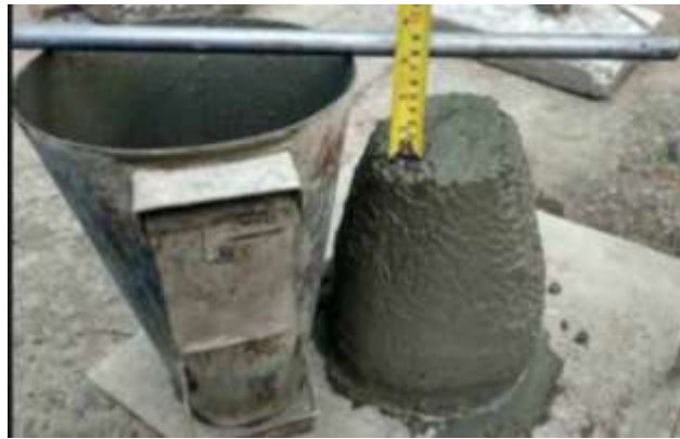
Figura 4. Prueba SLUMP mediante el cono de Abraham
