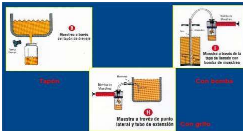
Figura 17: Métodos de muestreo de aceite.
