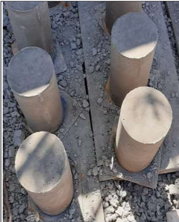
Figura 4. Especímenes de concreto elaboradas.
