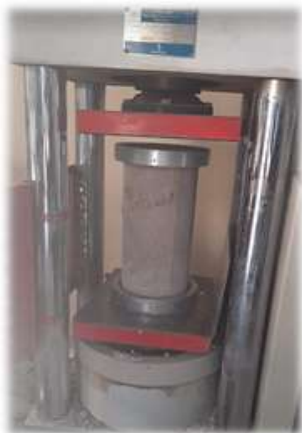
Fotografía 11. Probeta con falla despues de la rotura.
