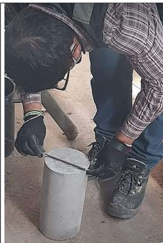
Figura 9. Medición del área de los especímenes de concreto.
