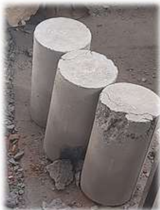
Fotografía 12. Falla de las probetas de concreto.
