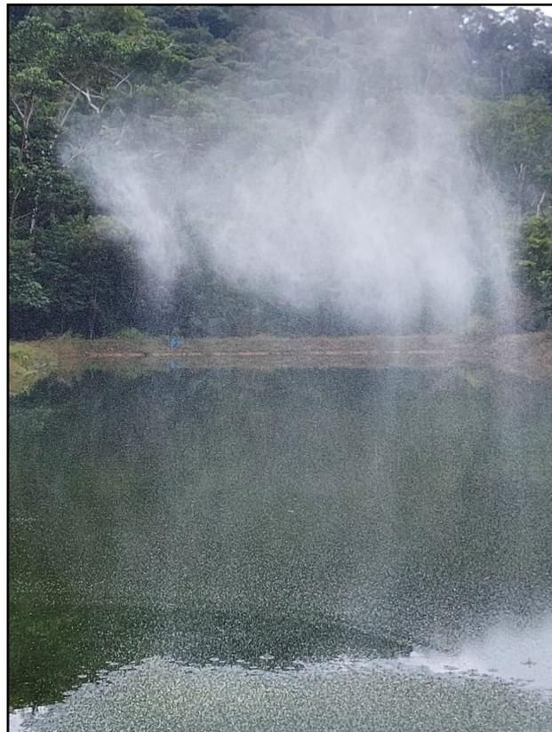
Figura 13: Aplicación del sulfato de aluminio a la laguna de desinfección de la PTAR
