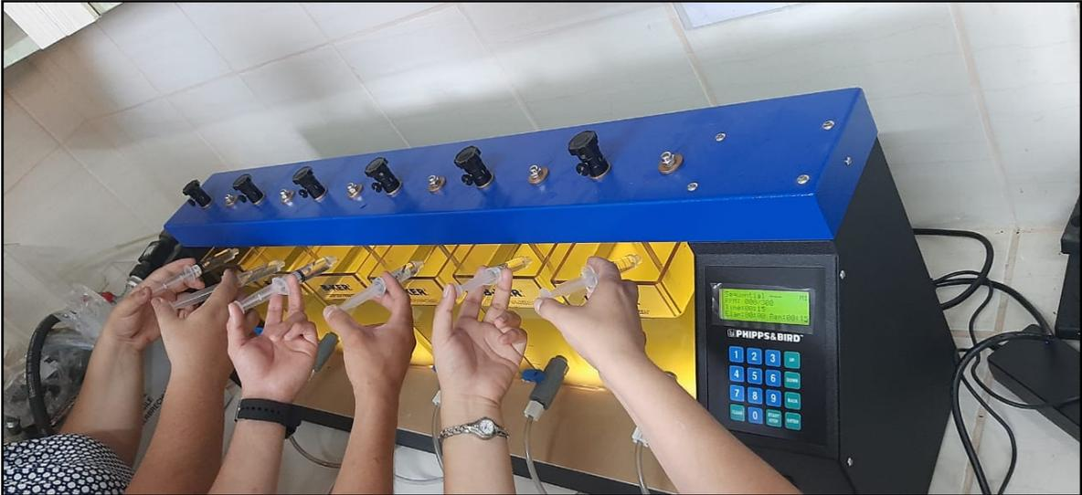
Figura 12: Prueba de Jarras, aplicación el sulfato de aluminio
