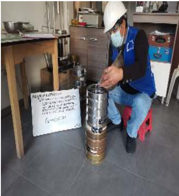
Fig. n° 05 y Fig. n° 06: Vista del análisis granulométrico por Tamizado ASTM D – 421 de los agregados
