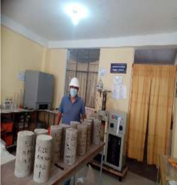
Fig. n°09 y Fig. n°10 Vista de las Probetas Cilíndricas para los ensayos de resistencia a la compresión a los 7 días de acuerdo a la norma ASTM C 31M
