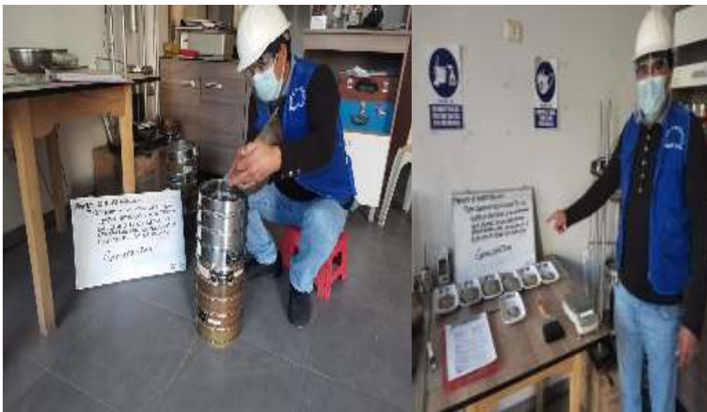
Figura 10. Análisis granulométrico de la piedra chancada
