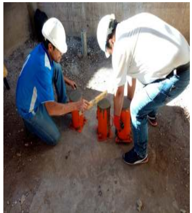
Fig. n°07 y Fig. n° 08: Vista del llenado y compactado de concreto en las briquetas cumpliendo con las normas, compactado con una varilla 25 veces en cada capa
