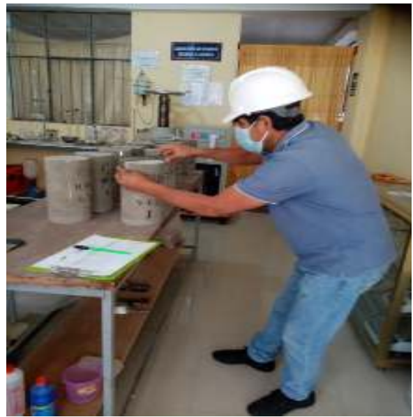
Fig. n°09 y Fig. n°10 Vista de las Probetas Cilíndricas para los ensayos de resistencia a la compresión a los 7 días de acuerdo a la norma ASTM C 31M
