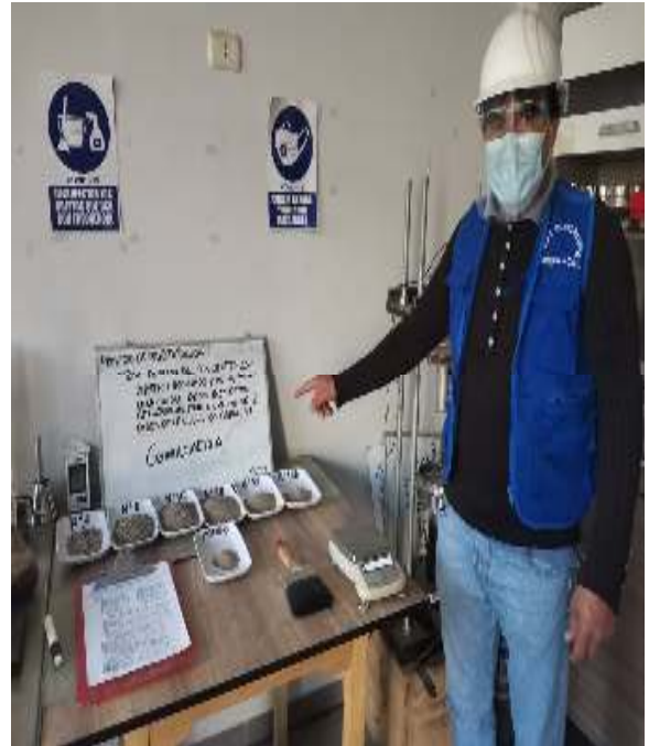
Fig. n° 05 y Fig. n° 06: Vista del análisis granulométrico por Tamizado ASTM D – 421 de los agregados
