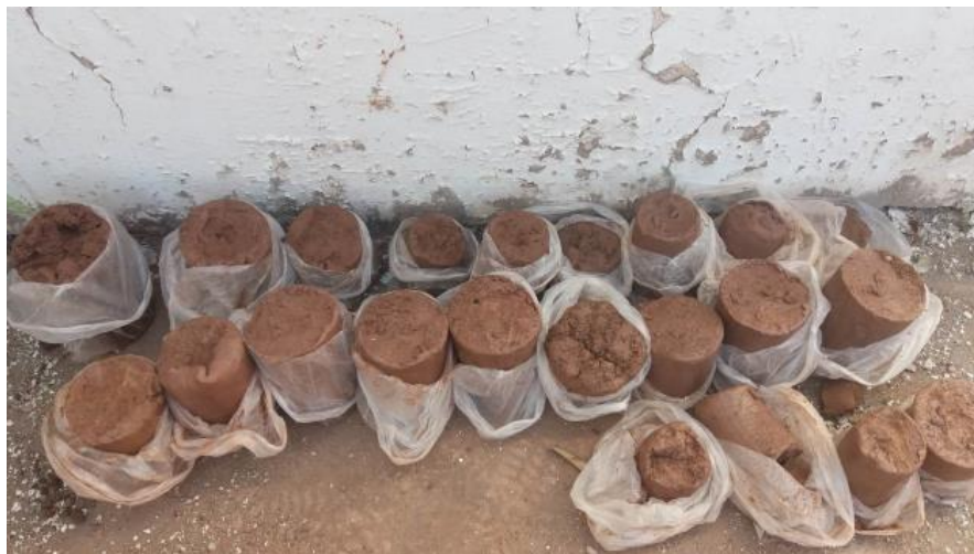
Figura N° 16: Muestras extraídas de perforación en Pz-02
