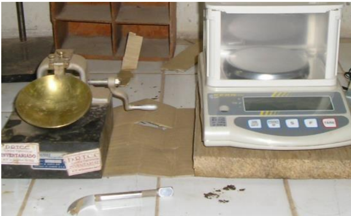
Figura N° 30: Equipo para límite líquido del suelo DRTC-MTC.
