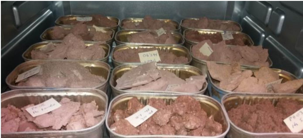
Figura N° 28: Muestra en horno para ensayo de humedad.
