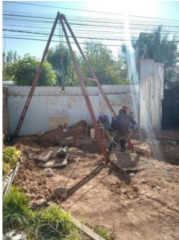
Figura N° 20: Trípode para generar onda
