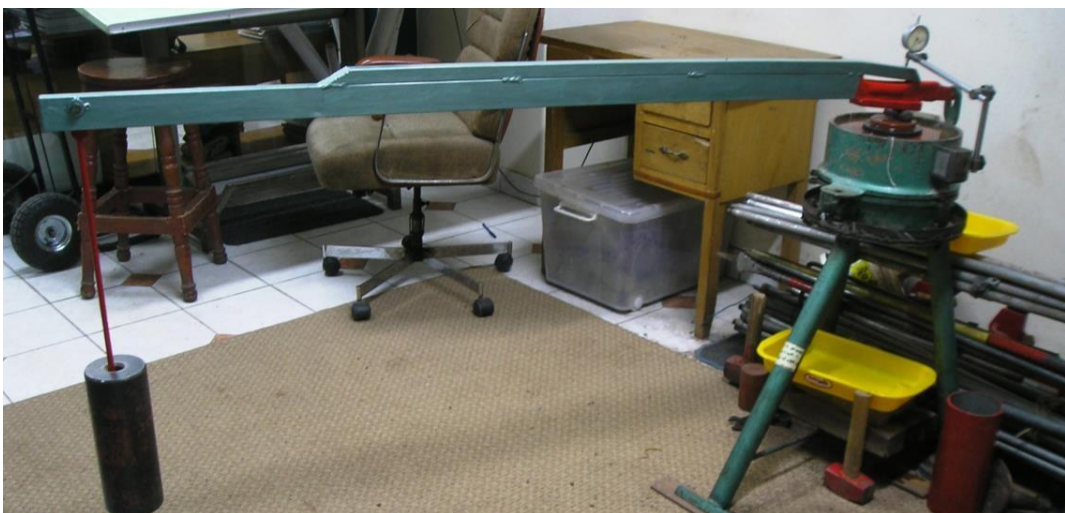
Figura N° 34: Equipo de corte directo, gravas con palanca de carga normal.
