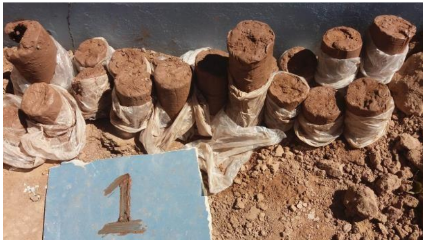
Figura N° 15: Muestras extraídas de perforación en Pz-01
