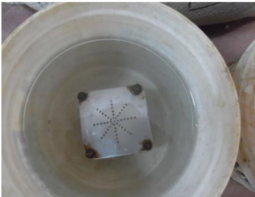
Figura N° 32: Saturación de especímenes confinados.
