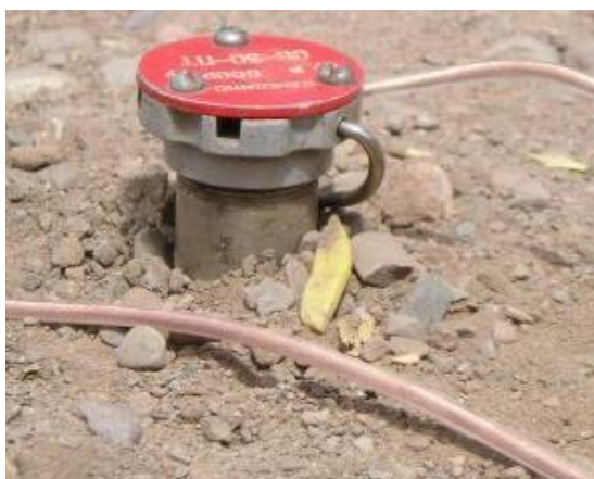
Figura N° 22: Detalle del geófono utilizado.
