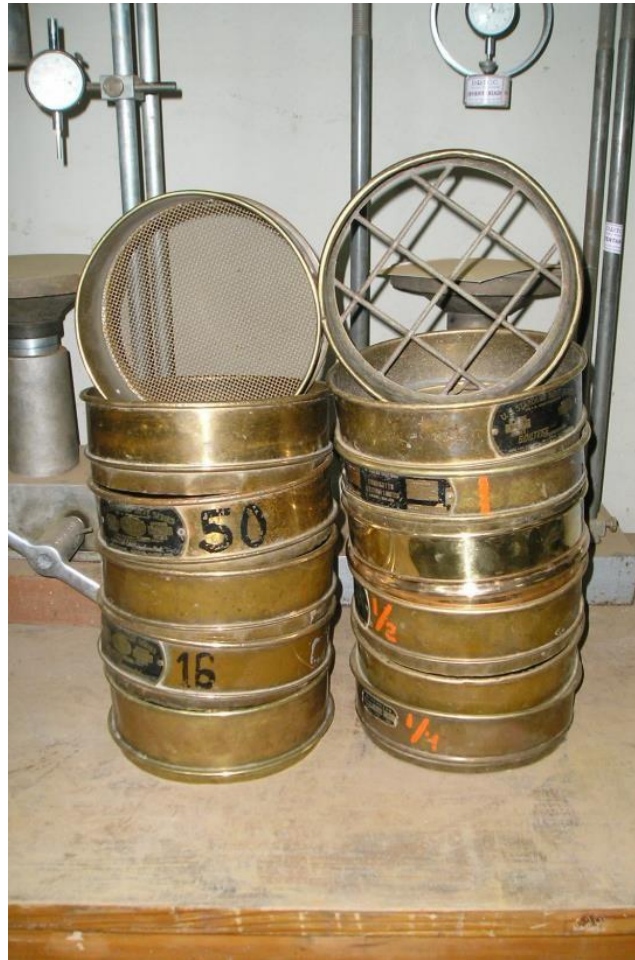
Figura N° 31: Columnas de tamices para granulometría DR-MTC
