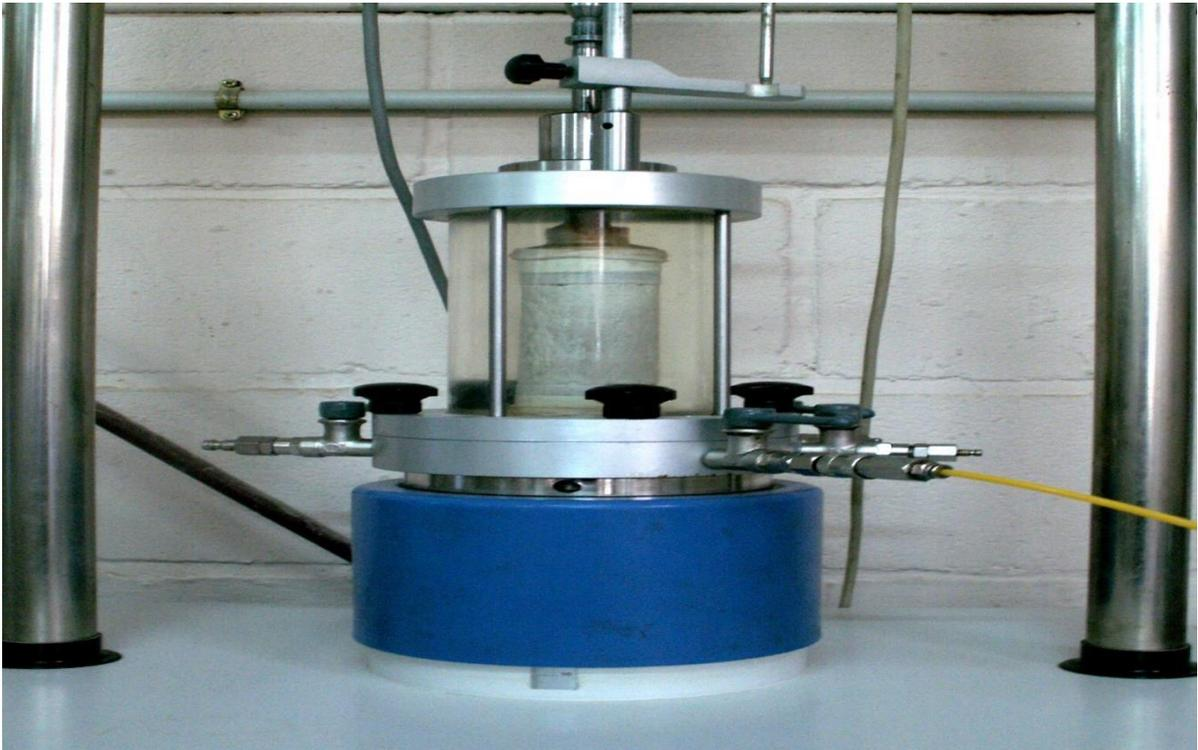
Figura 3. Ensayo de compresión triaxial. Fuente: (Revista Arquitectura e Ingeniería, 2018, p. 4)
