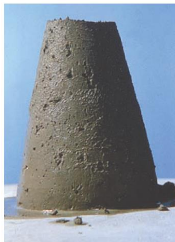
Figura 4: Características típicas de un concreto con alta y baja trabajabilidad, tomado de "Design and Control of concrete mixtures", Hostmatka y Wilson 2015.
