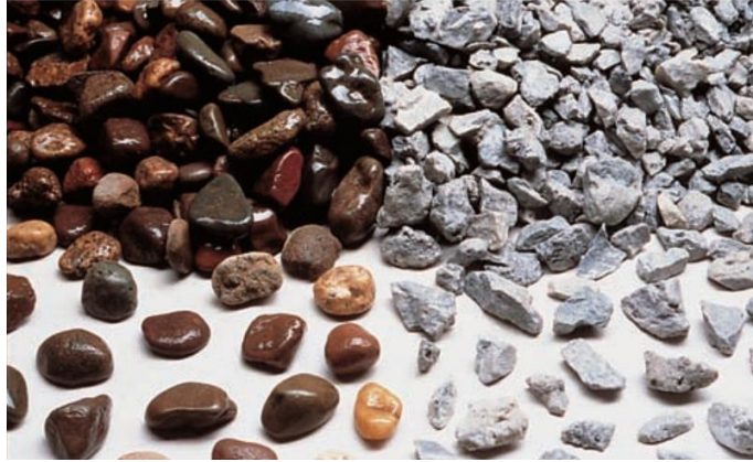
Figura 2: Agregado grueso: grava angular (Derecho) y grava redondeada de río (izquierda). Tomado de Design and Concrete Mixtures, PCA.
