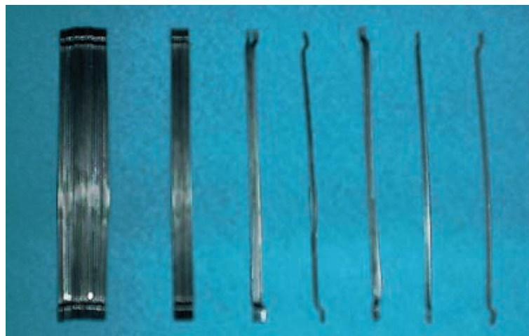
Figura 7: Diferente tipos de fibras de acero usadas en las mezclas de concreto, tomado de Design and Control of Concrete Mixtures, Hosmatka y Wilson (2015). Como se puede observar, las fibras de acero son materiales de construcción en los que una dimensión predomina sobre las otras, por tanto, tienen la forma de filamentos o hilos de poca longitud. Una descripción menos rigurosa, pero más gráfica, describiría a estos elementos como cabellos de longitud variable.
