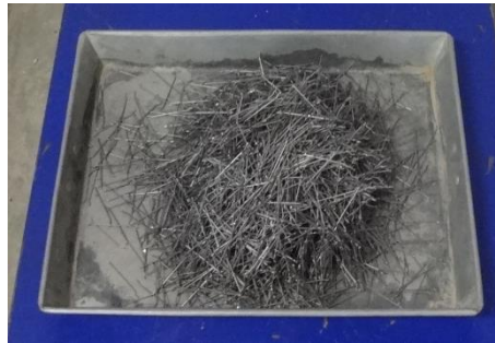
Figura 10: Fibras de acero en el concreto.
