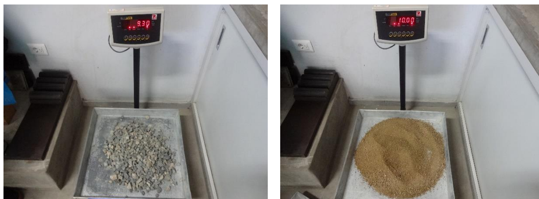
Figura 11: Primeros pasos en la elaboración del concreto reforzado con fibras de acero. Fuente: Elaboración propia.
