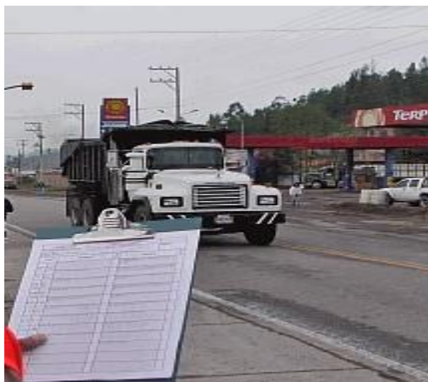
Figura 21: Estudio del impacto vehicular en las cargas transmitidas al pavimento rígido. Fuente:
