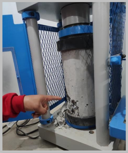
Imagen 40 y 41. Rotura de briquetas
