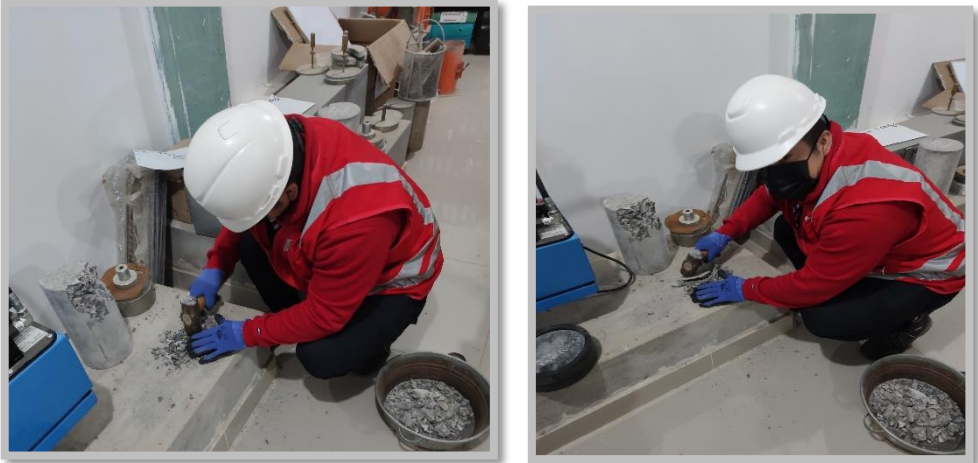
Imagen 31 y 32. Trituración de concreto para ensayo de pH
