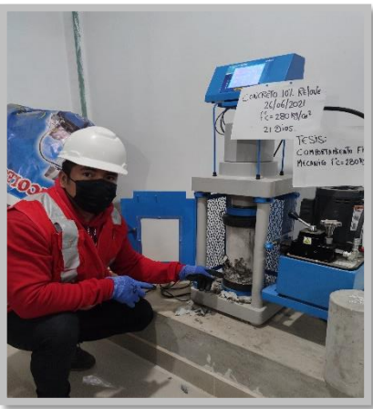
Imagen 38 y 39. Rotura de briquetas
