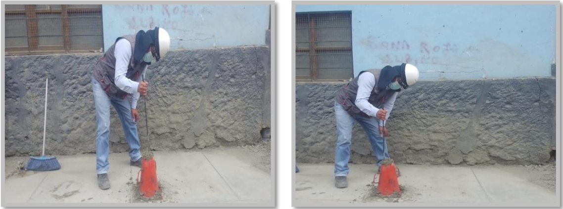
Imagen 25 y 26. Compactado con varilla de punta circular
