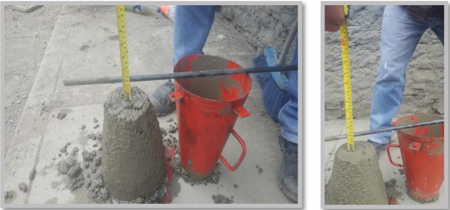
Imagen 29 y 30. Medición de Slump
