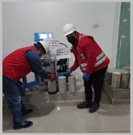
Imagen 38 y 39. Rotura de briquetas
