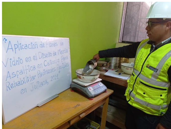
Figura 12: Pesaje del cemento asfáltico (Cal).
