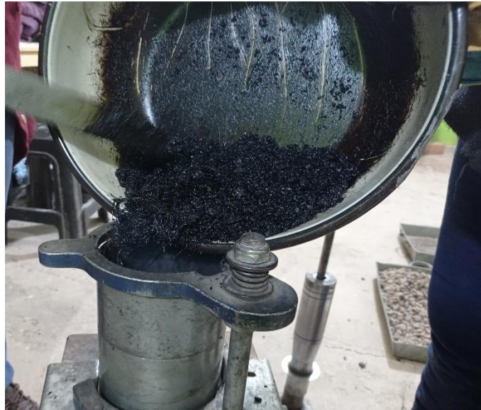
Figura 19: Colocación de la mezcla asfáltica en el molde
