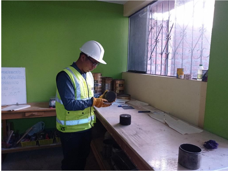
Foto 09: Lijado de las briquetas.
