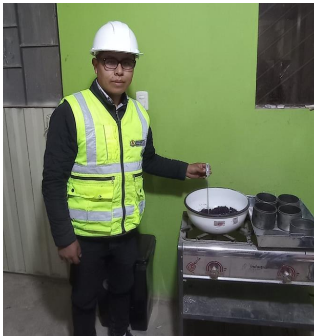
Figura 16: Muestra homogénea con PEN, con temperatura a 140 °C.
