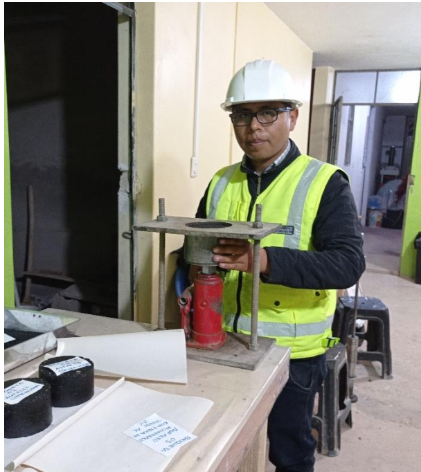
Figura 21: Extracción de las briquetas del molde Marshall.
