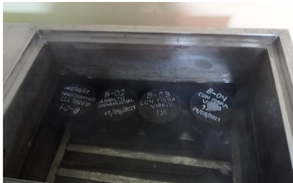
Figura 25: Briquetas puestos en Baño María.
