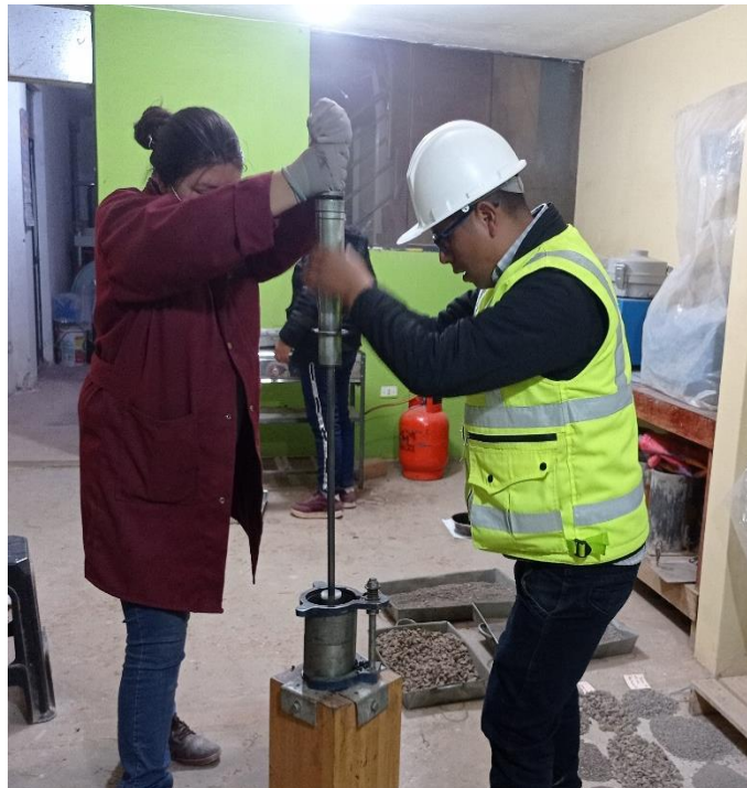
Figura 20: Compactación 75 golpes por cada cara del molde.
