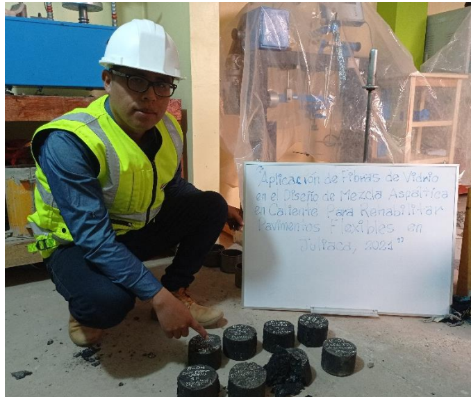
Figura 28: Briquetas de acuerdo a su rotura.
