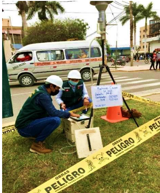
Figura 09: Instalación y prueba de energía del muestreador de partículas
