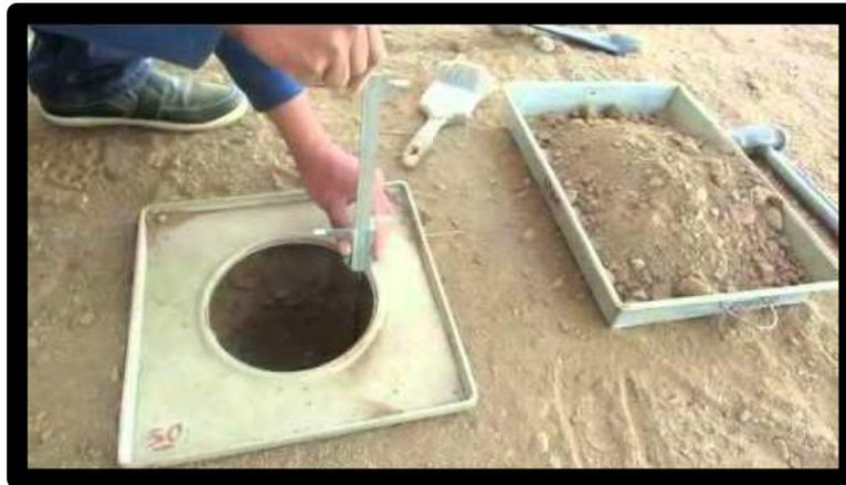
**Figura 9** Placa Base de Material Metálico
