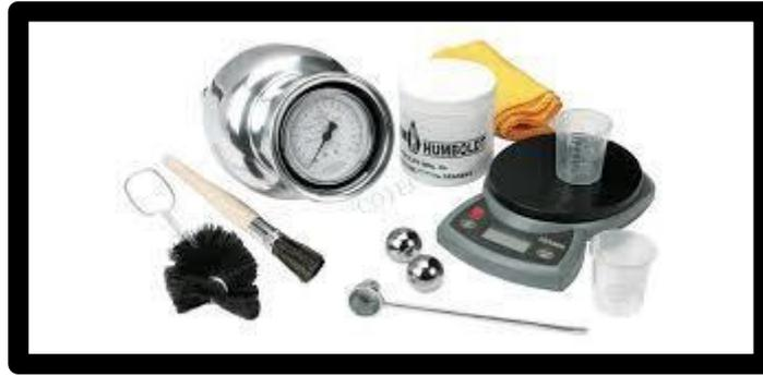
**Figura 11** Medidor de humedad "Tipo Speedy"
