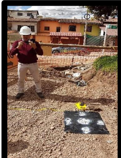
**Figura 22** Predisposición del martillo Proctor y el Geófono microtrepidador.
