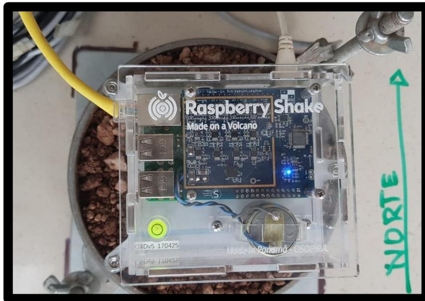
**Figura 3** Raspberry Shake (Geófono sísmico personalizado)
