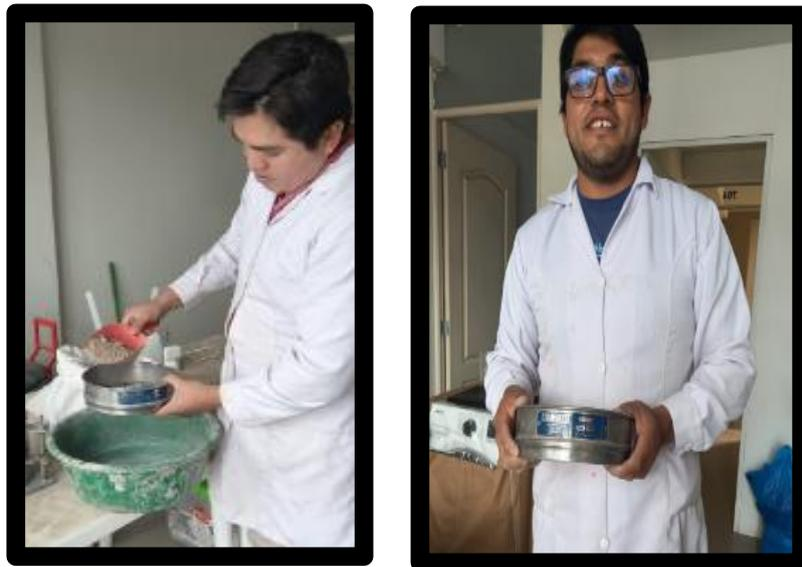
**Figura 33** Se realizó el tamizado del material de la sub base del pavimento de la calle Gordon Magne en la malla 3/4
