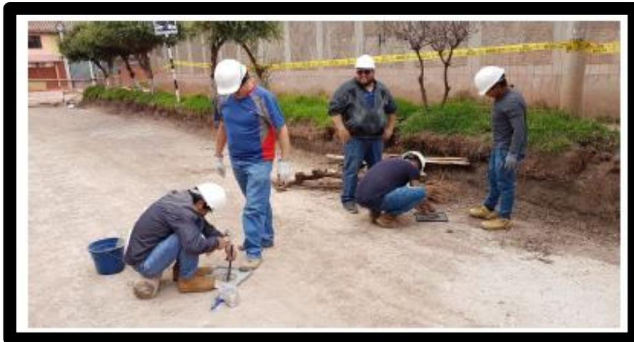
**Figura 12** Ensayo de Cono de arena.
