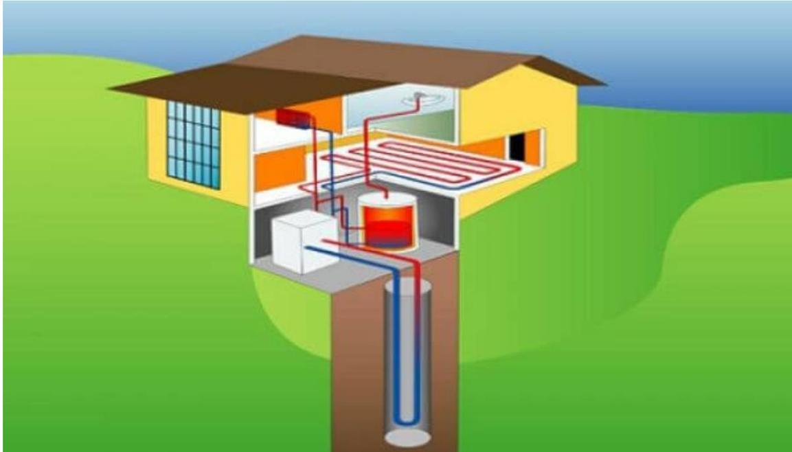
*Nota.* La imagen muestra como el calor de la tierra puede ser dirigido hacia la vivienda a través de tuberías instaladas bajo tierra. <https://arquitectura-sostenible.es/diferentes-aplicaciones-de-la-geotermia/>
