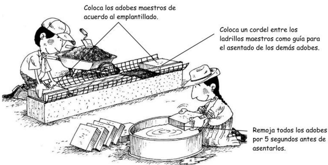
*Nota.* La imagen muestra cual es el proceso de colocación del adobe y la unión con la geomalla. [http://files.pucp.edu.pe/posgrado/wp-content/uploads/2015/09/24233900/Manual-Construcci%C3%B3n-Adobe-reforzado-con-mallas-de-Driza -final.compressed.pdf](http://files.pucp.edu.pe/posgrado/wp-content/uploads/2015/09/24233900/Manual-Construcci%C3%B3n-Adobe-reforzado-con-mallas-de-Driza-final.compressed.pdf)
