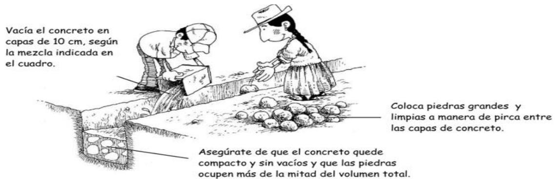
*Nota.* La imagen muestra el vaciado de la mezcla sobre la zanja para que sirvan como base de la construcción. [http://files.pucp.edu.pe/posgrado/wp-content/uploads/2015/09/24233900/Manual-Construcci%C3%B3n-Adobe-reforzado-con-mallas-de-Driza\\_-final.compressed.pdf](http://files.pucp.edu.pe/posgrado/wp-content/uploads/2015/09/24233900/Manual-Construcci%C3%B3n-Adobe-reforzado-con-mallas-de-Driza_-final.compressed.pdf)
