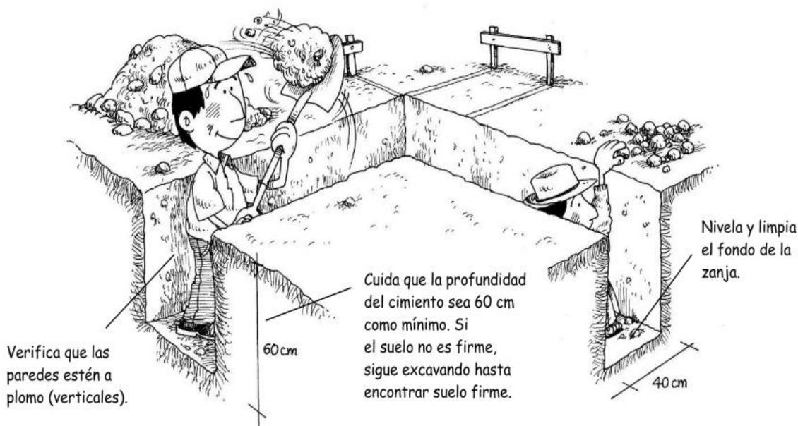
*Nota.* En la imagen presentada se observa la excavación de la zanja para el respectivo llenado de la mezcla. [http://files.pucp.edu.pe/posgrado/wp-content/uploads/2015/09/24233900/Manual-Construcci%C3%B3n-Adobe-reforzado-con-mallas-de-Driza -final.compressed.pdf](http://files.pucp.edu.pe/posgrado/wp-content/uploads/2015/09/24233900/Manual-Construcci%C3%B3n-Adobe-reforzado-con-mallas-de-Driza-final.compressed.pdf)
