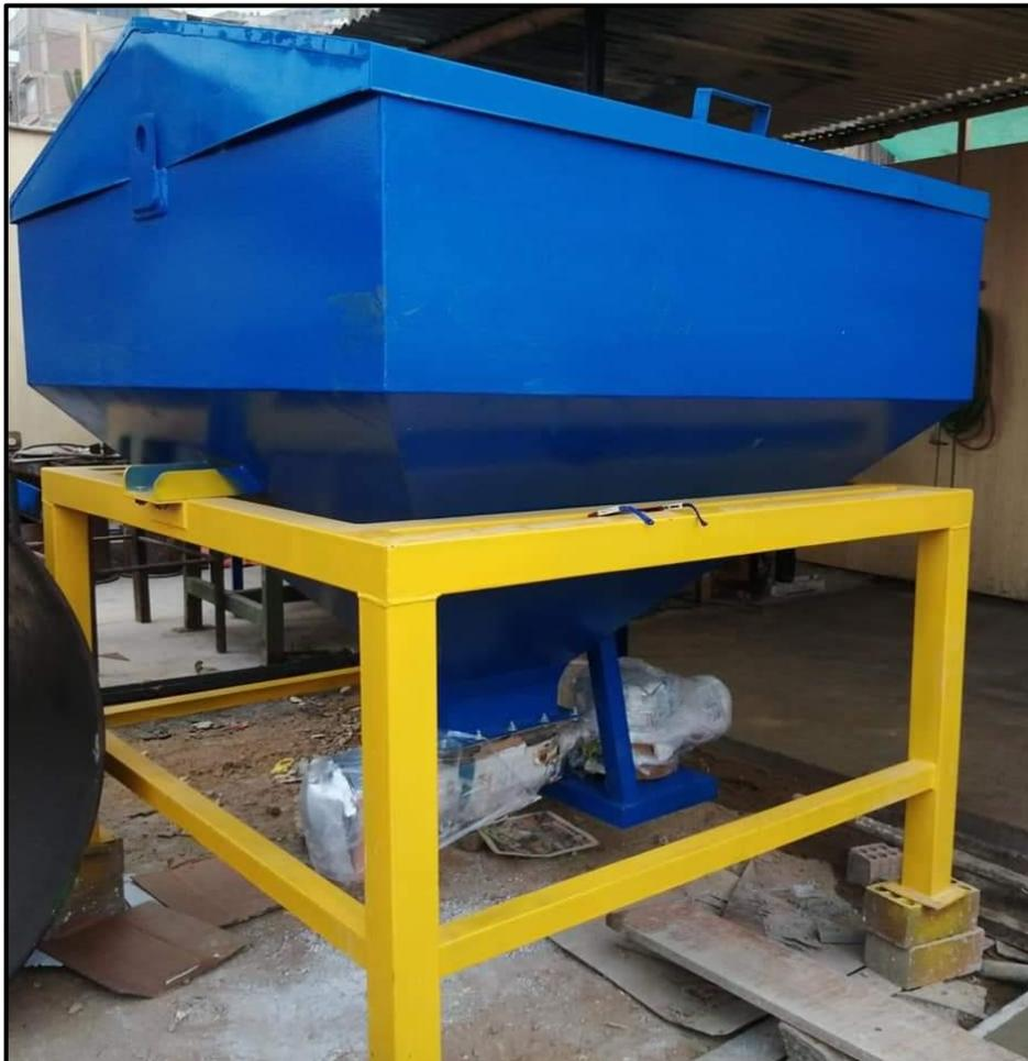
**Figura 10. Dosificador Sinfín Armado**
