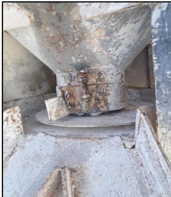
***Figura 3. Disco de control de vertido en el dosificador convencional***
