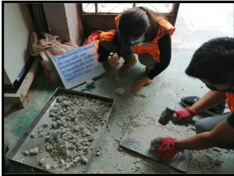
Figura N 5: concreto reciclado triturado
