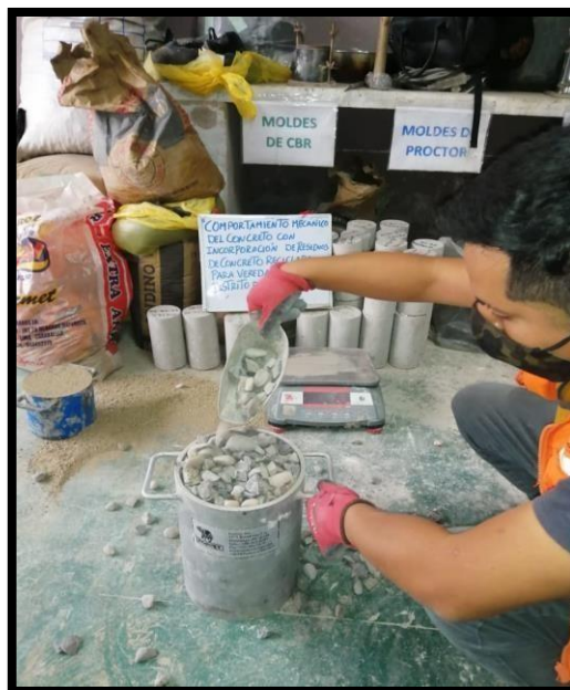
Figura N° 16: agregado grueso por el método suelto
