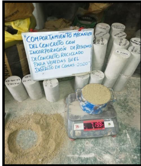
Figura N° 12: muestra obtenida del agregado fino por el método compactado.
