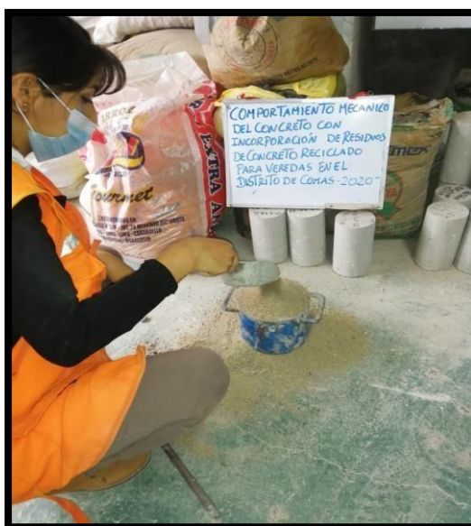
Figura N 9: agregado fino al método alzada
