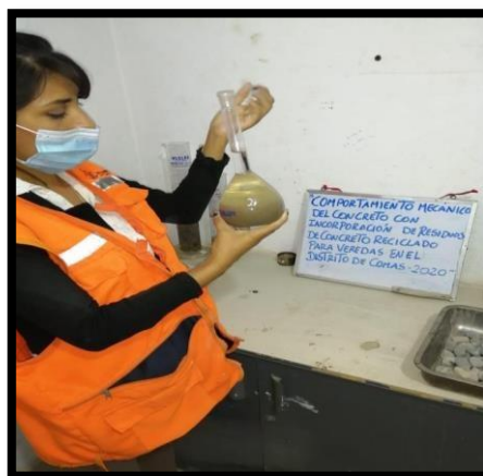
Figura N° 13: Ensayo de absorción del agregado fino
