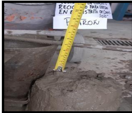
Figura N°30: Slump deseada. Elaboración propia
