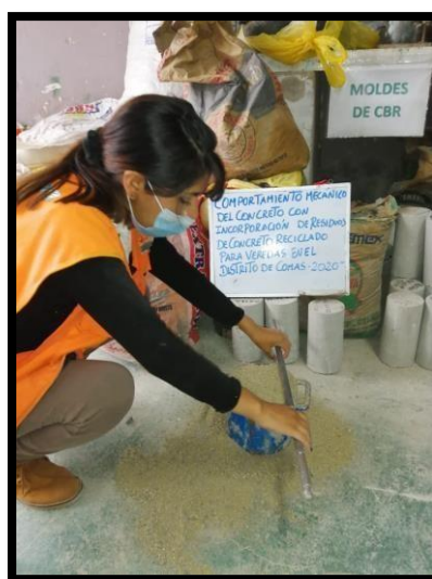
Figura N° 10: muestra obtenida del agregado fino por el método alzada.
