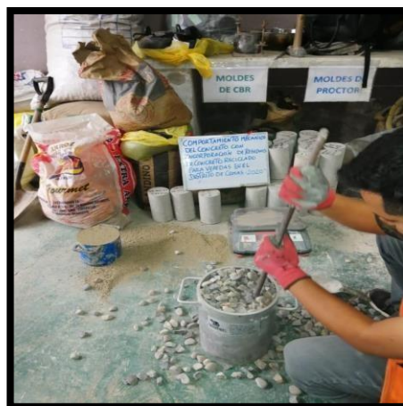
Figura N° 18: liberando aire del cilindro de metal
