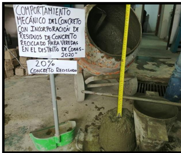
Figura 34. Slump deseada. Elaboración propia,2020.
