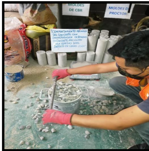
Figura N° 17: rasado de agregado grueso
