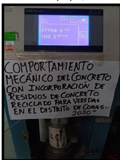
Figura 39. Testigos a la resistencia a compresión 7 días, con concreto reciclado al 50%. Elaboración propia, 2020.
