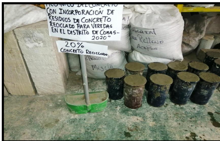
Figura N° 24: probetas de concreto reciclado con el 20%
