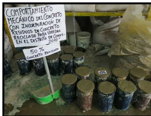
Figura N° 26: Probetas de concreto reciclado con el 50%
