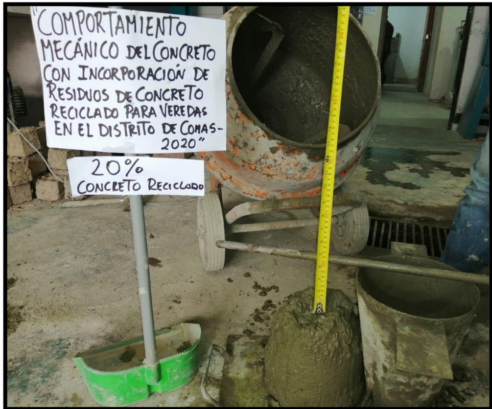
Figura N° 23: slump del concreto con 20%
