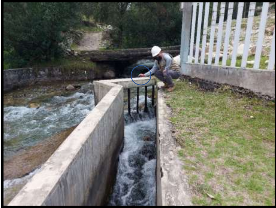
FOTOGRAFÍA N°07 PRUEBA CON EL MÉTODO DEL FLOTADOR PARA LA MEDICIÓN DEL CAUDAL
