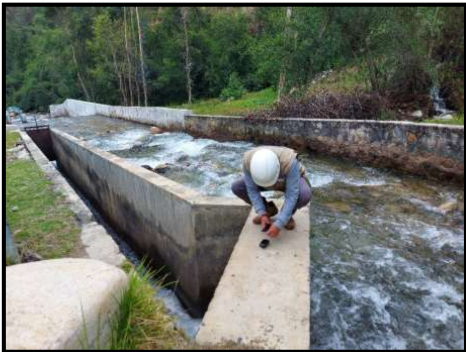
FOTOGRAFÍA N°02 TOMA DE PUNTOS UTM CON GPS ETREX 30
