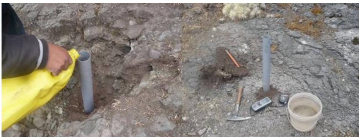
FOTO N°18 Y 19: se observa el ensayo de pruebas de infiltración realizadas en campo.
