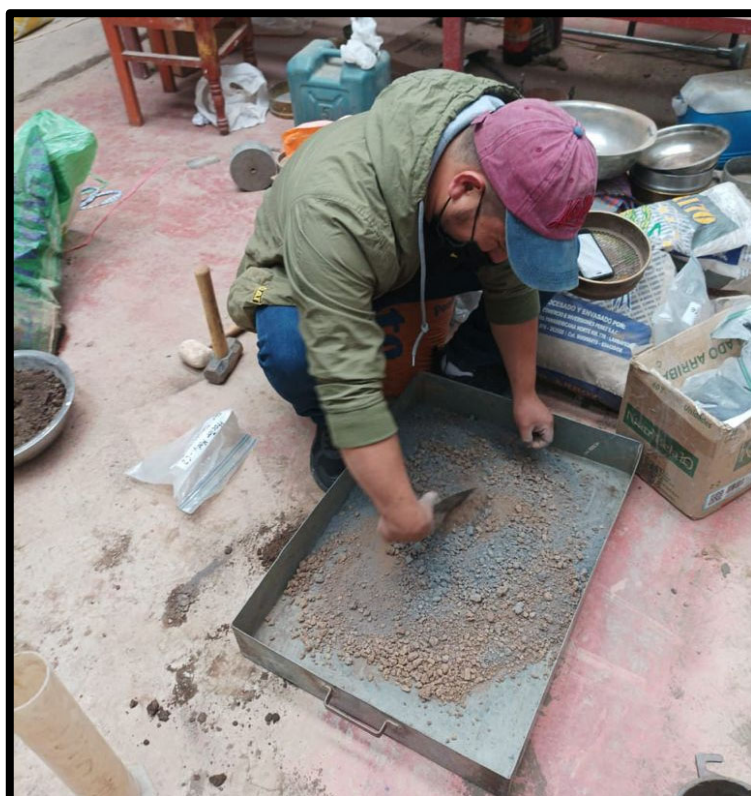
Figura 16: Mezclando la muestra con la ceniza de cebada
