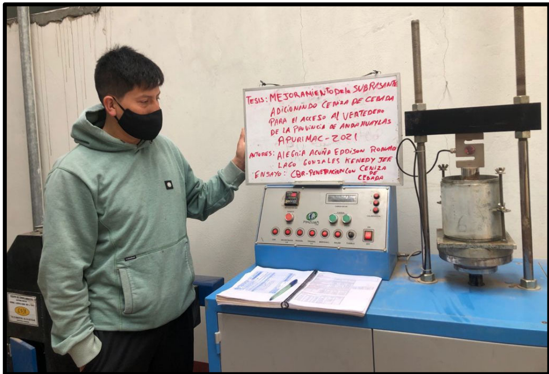
Figura 19: CBR –Penetración ceniza de cebada
