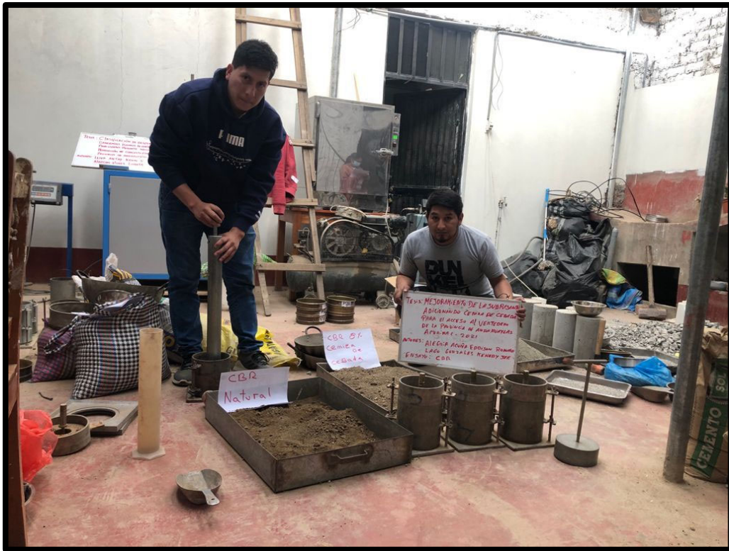
Figura 18: Ensayo CBR con expansión
