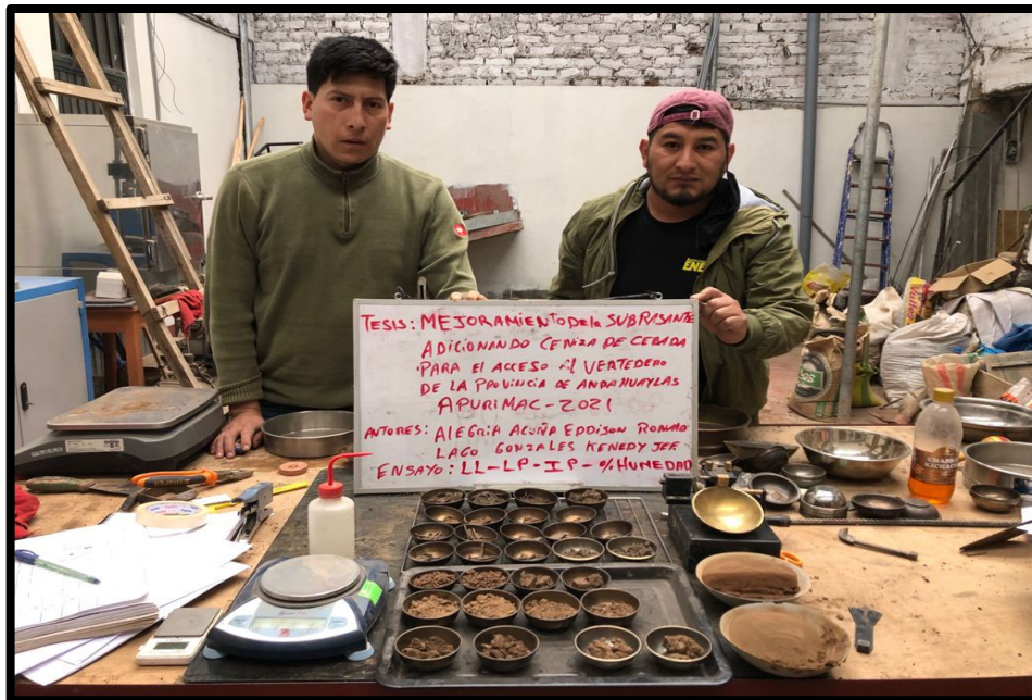
Figura 21: Ensayo de Límite Líquido, Límite Plástico, Índice de Plasticidad y Porcentaje De Humedad
