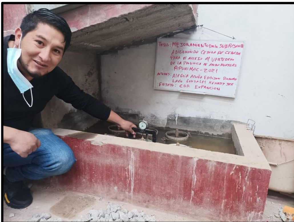
Figura 18: Ensayo CBR con expansión
