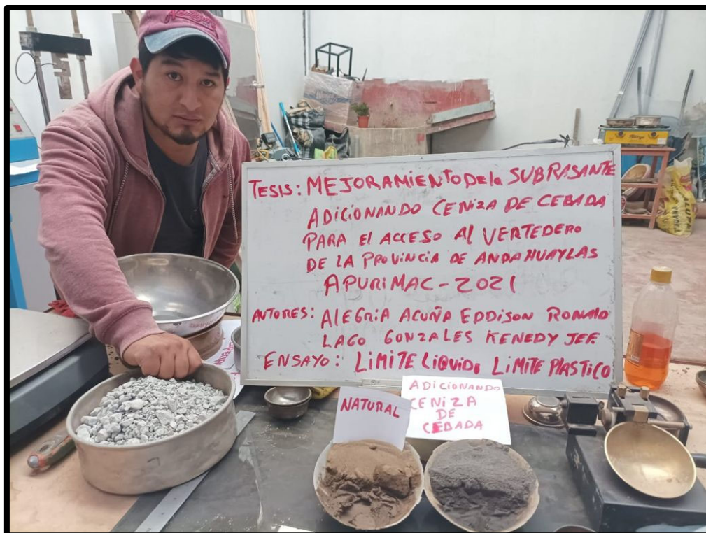
Figura 20: Ensayo De Limite Liquido y Limite Plástico
