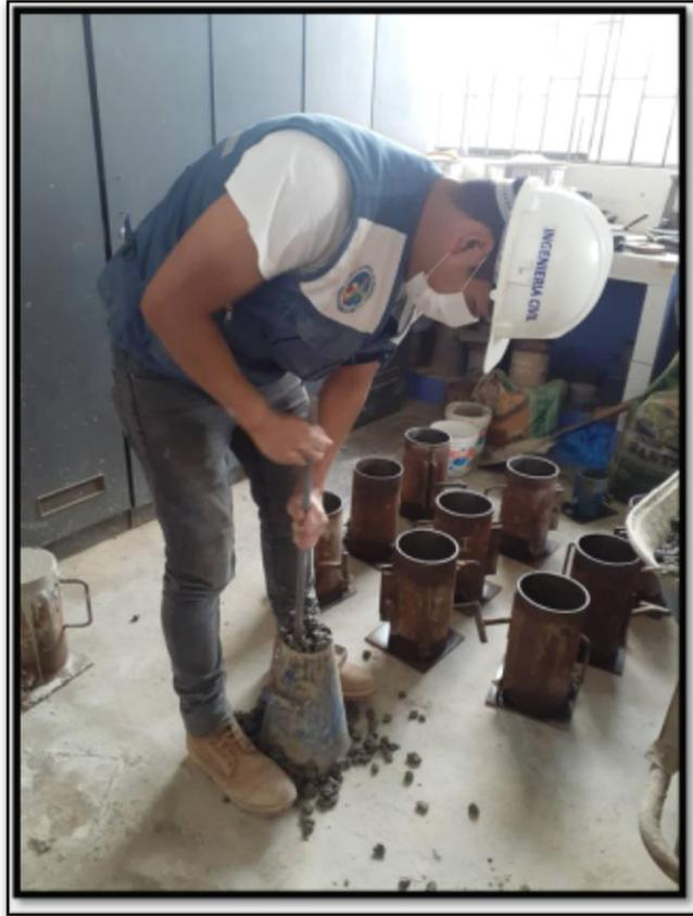
**Figura 34.** Ensayo del Cono de Abrams
