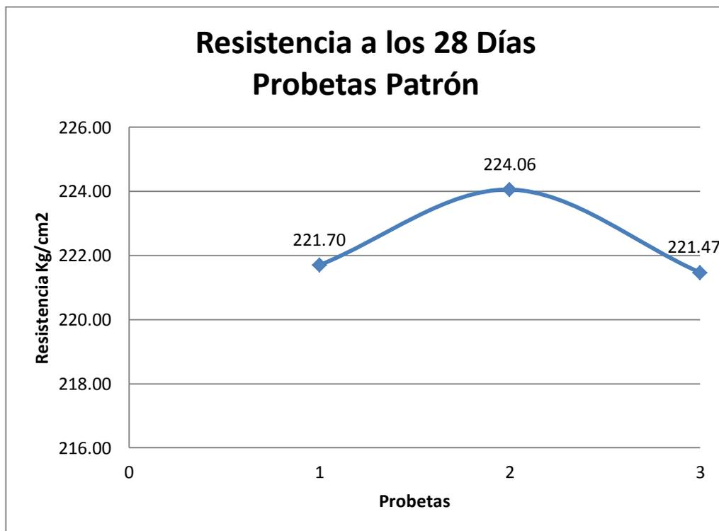
**Figura 9.** Resistencia a la Compresión de Probetas Patrón – 28 días
