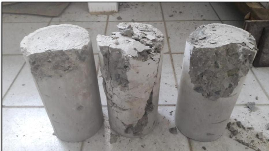
**Figura 37.** Rotura de Probetas
