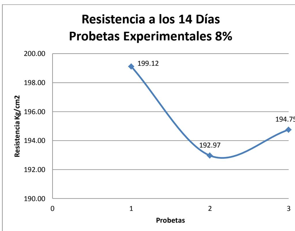
**Figura 14.** Resistencia a la Compresión de Probetas Experimentales 8% –14 días
