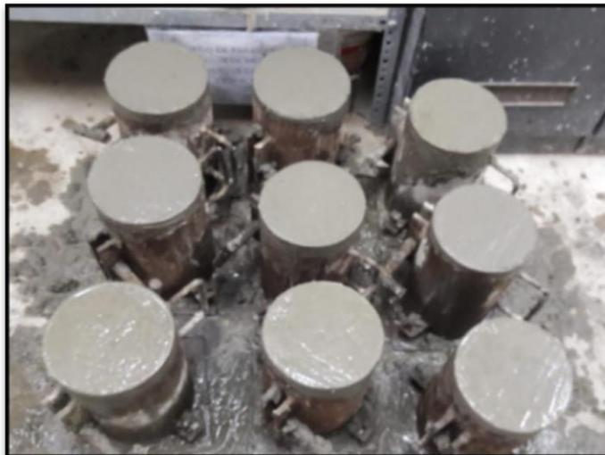
**Figura 35.** Elaboración de Probetas
