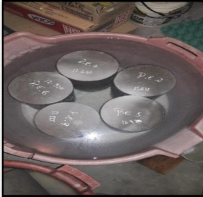
**Figura 36.** Curado de Probetas
