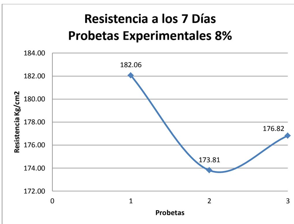
Figura 13. Resistencia a la Compresión de Probetas Experimentales 8% – 7 días
