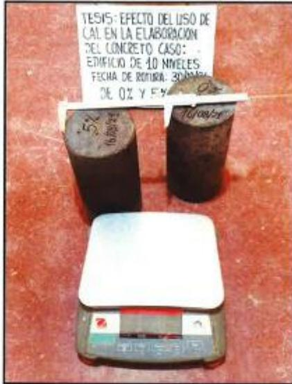
**Foto N° 1:** Vista de la probetas de concreto de 0 y 5 % de cal.
