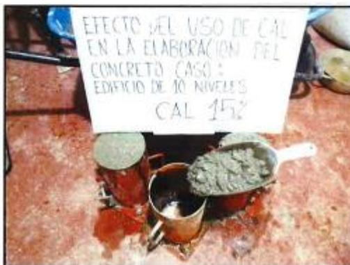
Foto N° 11: Elaboración de las probetas con 15% de Cal.
