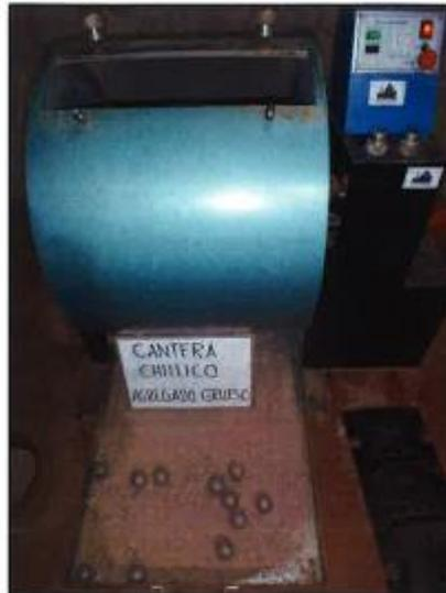
Foto N° 8: Ensayo de Abrasión.
