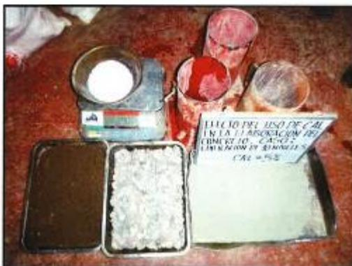
Foto N° 3: Elaboración de las probetas con 5% de Cal.
