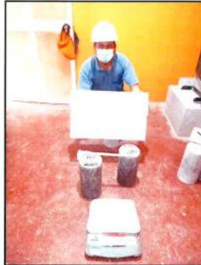
Foto N° 2: Vista de las probetas de concreto de 10 y 15 % de cal.
