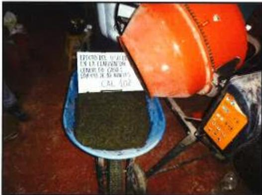
Foto N° 7: Elaboración de las probetas con 10% de Cal.
