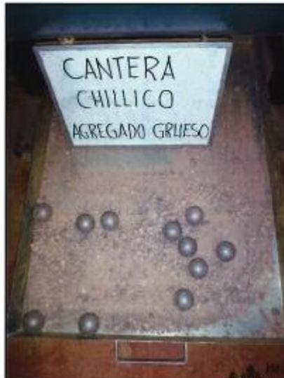
Foto N° 10: Ensayo de Abrasión.
