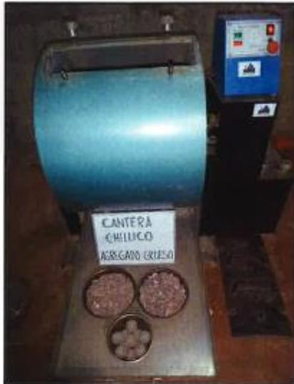
Foto N° 7: Ensayo de Abrasión.
