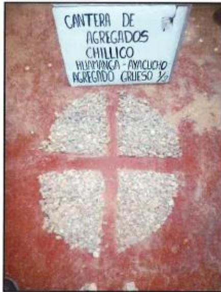
Foto N° 1: Ensayo de cuarteo de la muestra.
