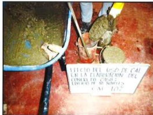
Foto N° 8: Elaboración de las probetas con 10% de Cal.
