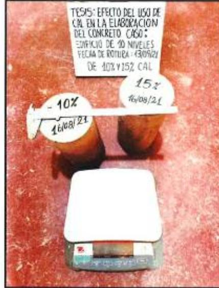
**Foto N° 2:** Vista de las probetas de concreto de 10 y 15% de cal.
