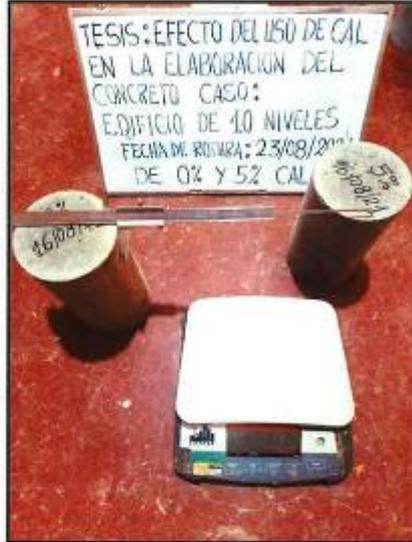
Foto N° 1: Vista de las probetas de concreto de 0 y 5 % de cal.
