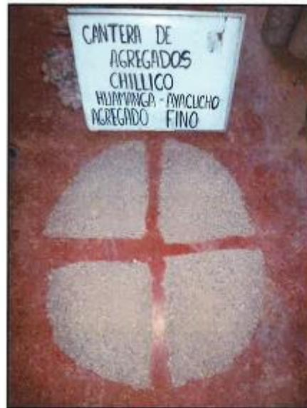
Foto N° 2: Ensayo de cuarteo de la muestra.
