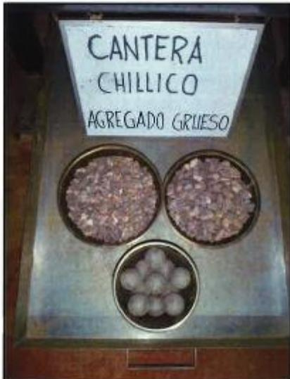
Foto N° 9: Ensayo de Abrasión.
