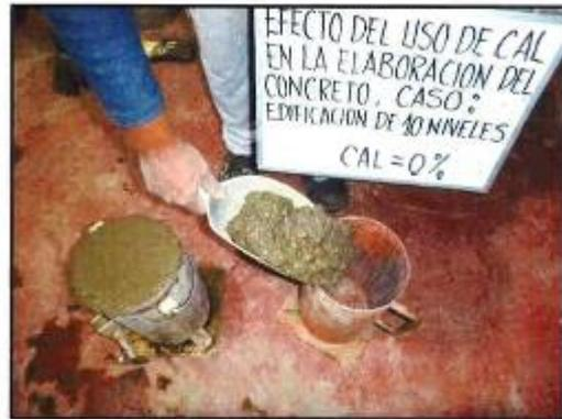
Foto N° 2: Elaboración de las probetas con 0% de Cal.
