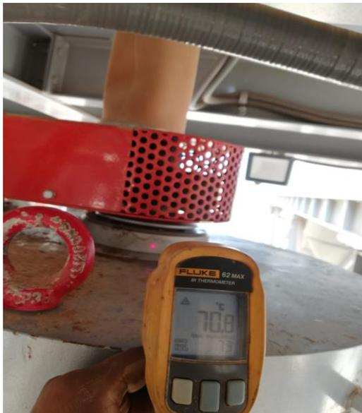
En la inspección se toma los datos de la temperatura en los puntos donde están los rodamiento o donde presenta rozamiento.
