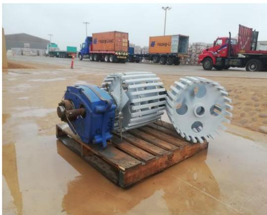
Se alista con tiempo los repuestos reparados y los que se mandaron a fabricar para hacer un trabajo rápido y la producción pueda continuar. Estos trabajos se realiza cuando hay 400 toneladas de arcilla en los silos.
