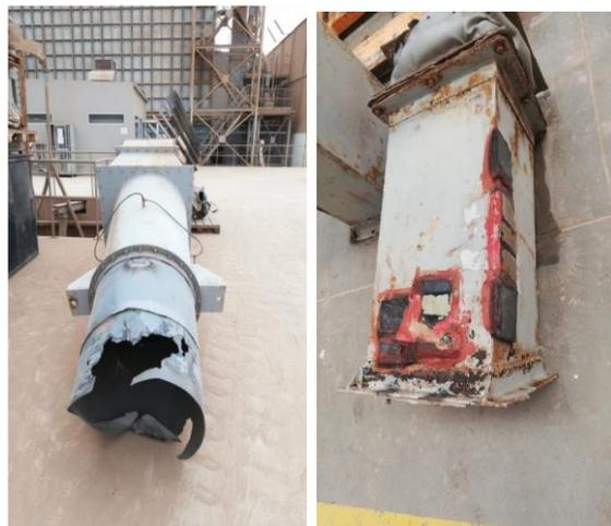
La contaminación por aceite es muy común que ocurra. Por el calentamiento de los retenes al no cambiarse a tiempo. La limpieza de aceite toma horas y provoca que la producción disminuya
