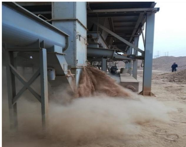
No hay inspecciones ni repuestos para cambiar fajas, estas se rompen y provocan contaminación en la arcilla votando toneladas de ella.
