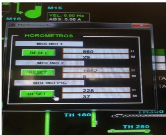
En el panel de control de la cabina se observa el horometro lo cual indica un cuanto falta para en mantenimiento general.
