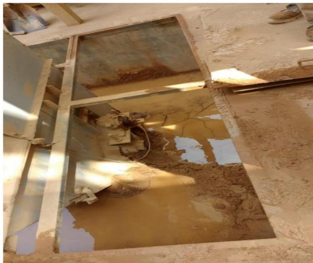
Maquina con desgaste provocan que el material se salga por todas partes, la falta de repuestos provoca que se desperdicie la materia prima
