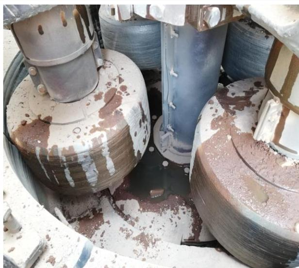
Los equipos del área de molienda son antiguos y en su mayoría presenta desgaste por oxidación. No se cambian por falta de repuestos. Y disposición de los equipos.
