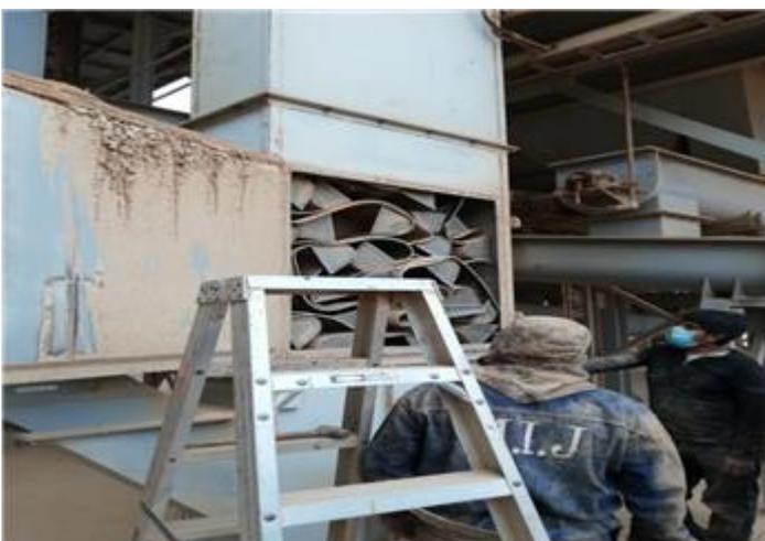
En varios puntos de las maquinas existe este problema de fuga de materia prima. Y no les dan solución y termina malogrando las chumaceras. Y el área para por ser un proceso continuo
