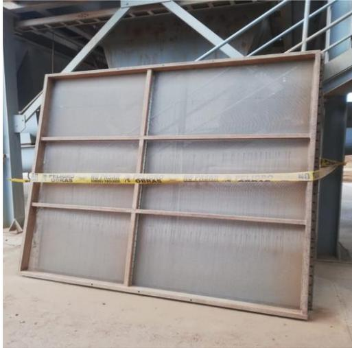
Las mallas de los tamices inclinados se programan para ser cambiados trimestral mente de su montaje. Para evitar que se rompa y contamine la arcilla. Se consiguió un repuesto para tener un cambio más rápido.
