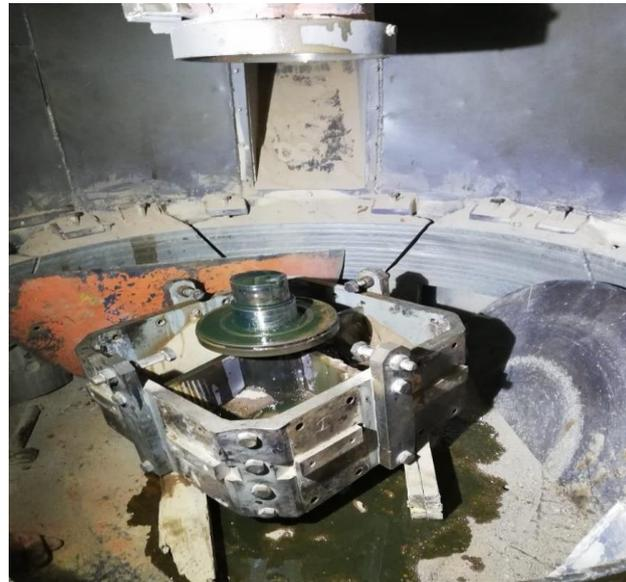
La arcilla es un material abrasivo y desgasta las estructuras por donde pasan, los ductos de aspiración del polvo son los que más se desgastan. Pero no se cambian por falta de material y bajo stock en los silos. Esto provoca que la eficiencia de los molinos disminuya y la calidad no sea la correcta.
