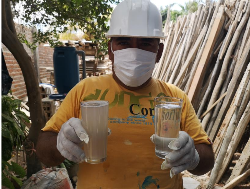
Fotografía 11. Demostración del agua, antes (lado izquierdo) del agua gris de pasar al filtrado. Lado derecho agua después del filtrado. Calle Sta. Isabel 352 AAHH. Sánchez cerro, Sullana.
