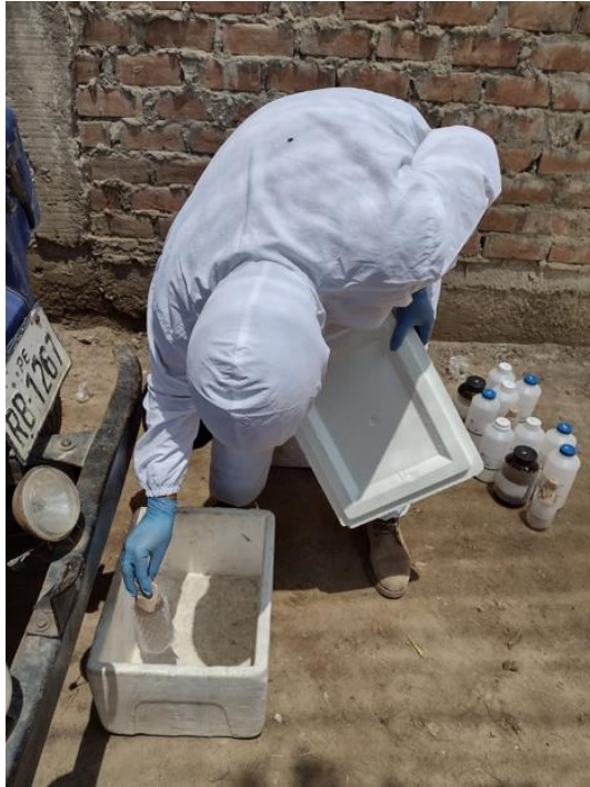
Fotografía 19. Colocación de los diferentes envases en un cooler para ser enviados al laboratorio.
