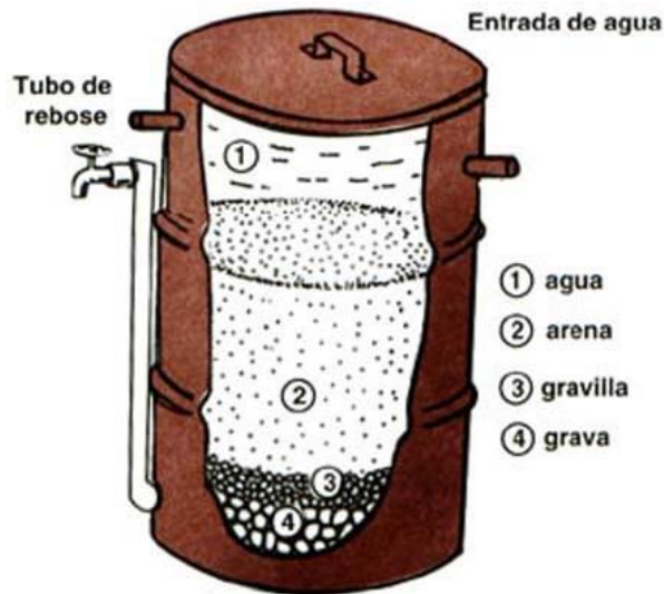
Figura 2: Filtro lento de arena compuesto por un tanque
