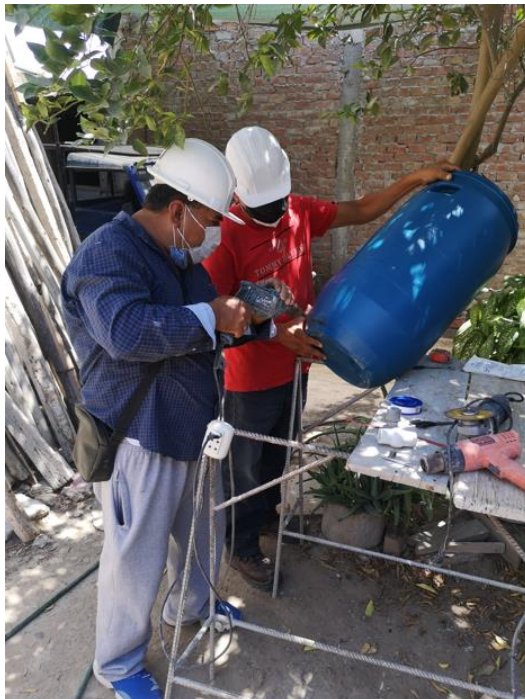
Fotografía 2. Realización del agujero. Donde se recibirá el agua después del filtrado. Agujero de ½" de diámetro.
