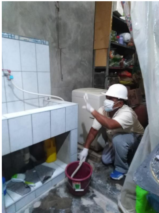
Fotografía 20. Método de recolección de aguas grises de lavadora para realizar el filtrado – Vivienda 1 Santa Isabel #511.
