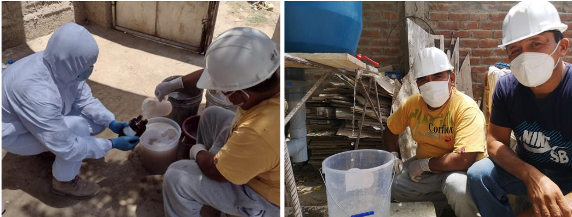
Figura 8: A la izquierda: muestreo de agua gris sin tratar. A la derecha: muestreo de agua gris tratada – Vivienda 1
