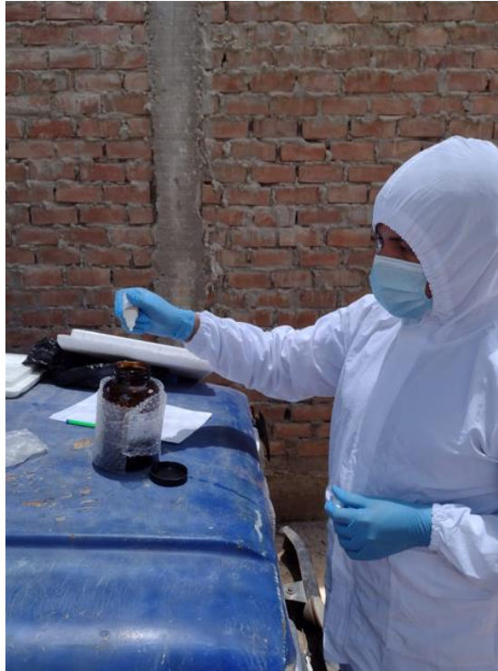
Fotografía 17. Utilización del ácido sulfúrico a los envases de vidrio indicados por el laboratorio para conservación de la muestra de agua.
