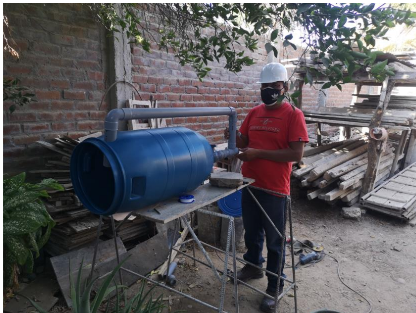
Fotografía 6. Culminación de armado de los diferentes accesorios utilizados en el filtrado de las aguas.
