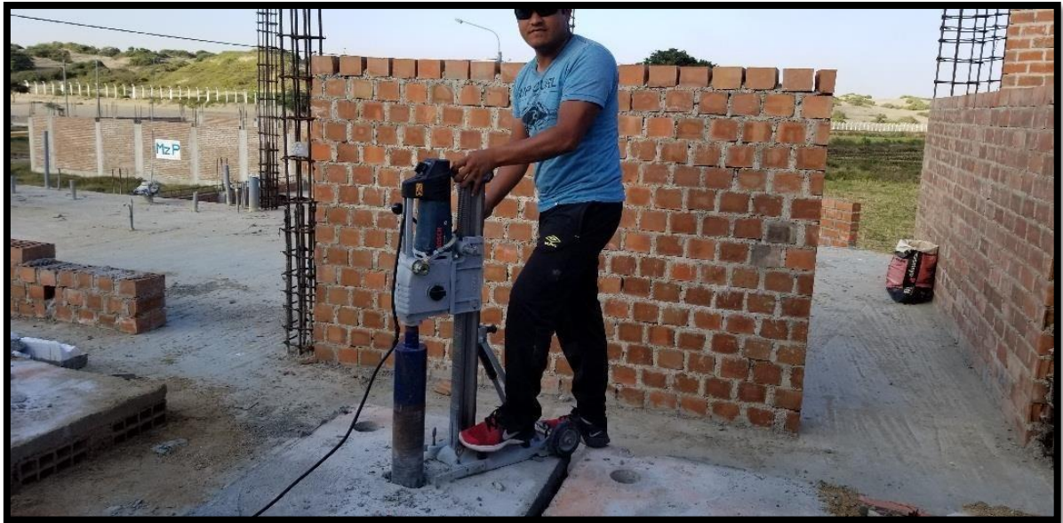
Figura 6: Ensayo de diamantina
