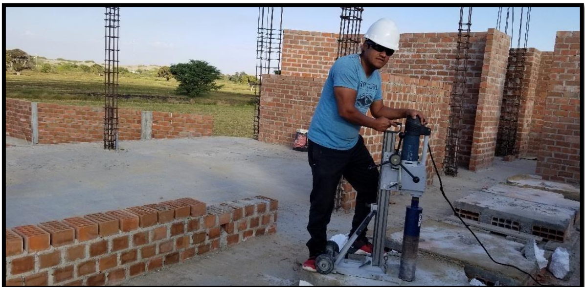
Figura 5: Ensayo de diamantina
