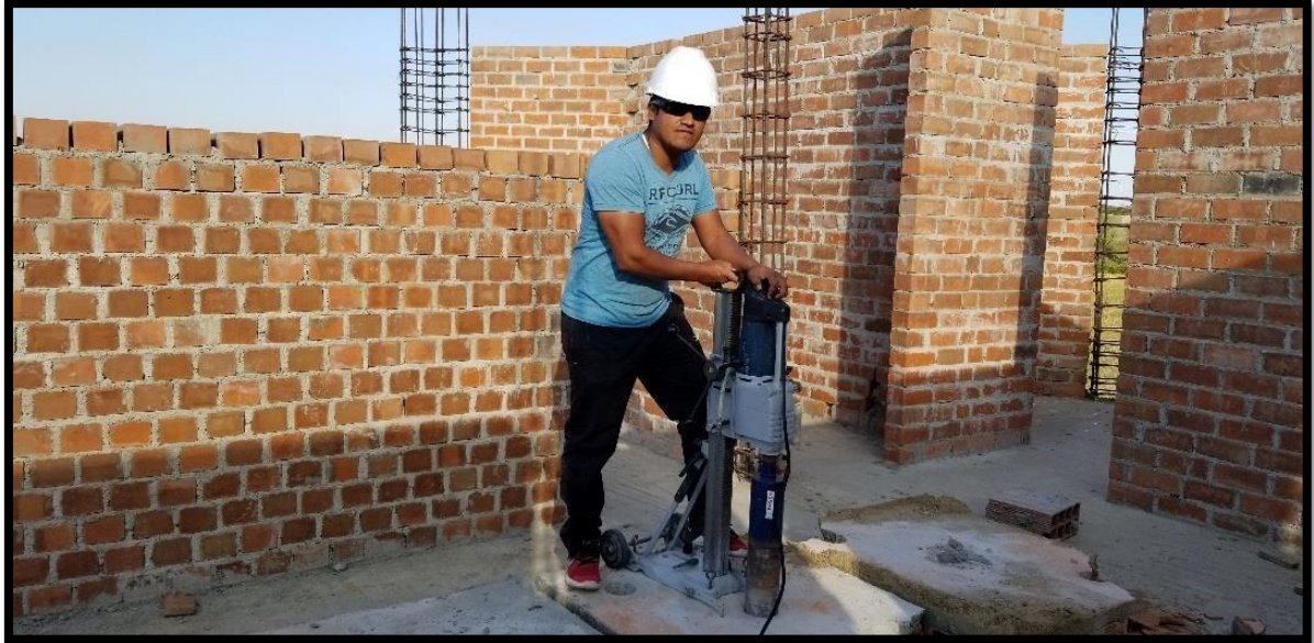
Figura 4: Ensayo de diamantina
