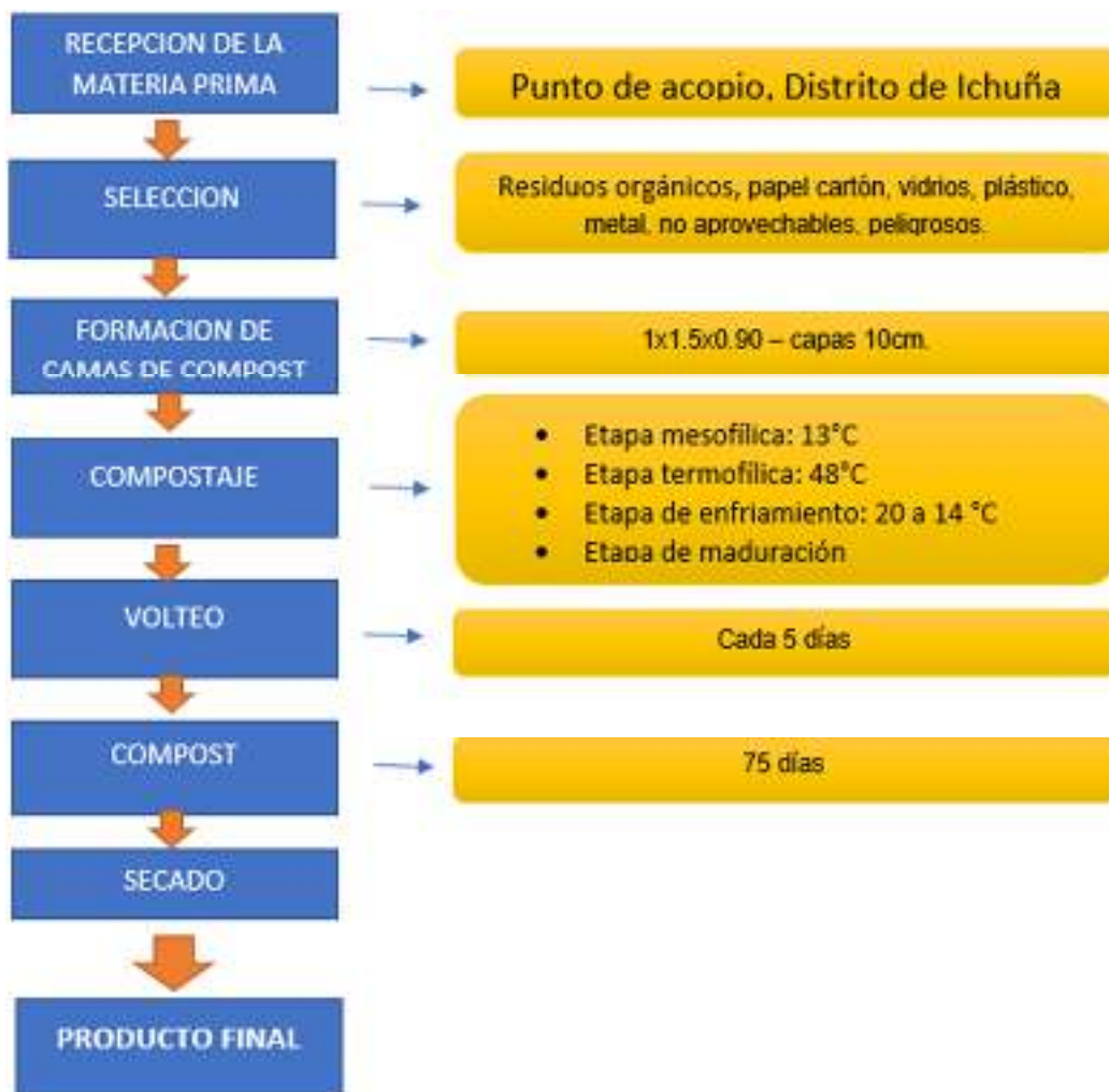
Gráfico 3. Diagrama de flujo para el compostaje.
