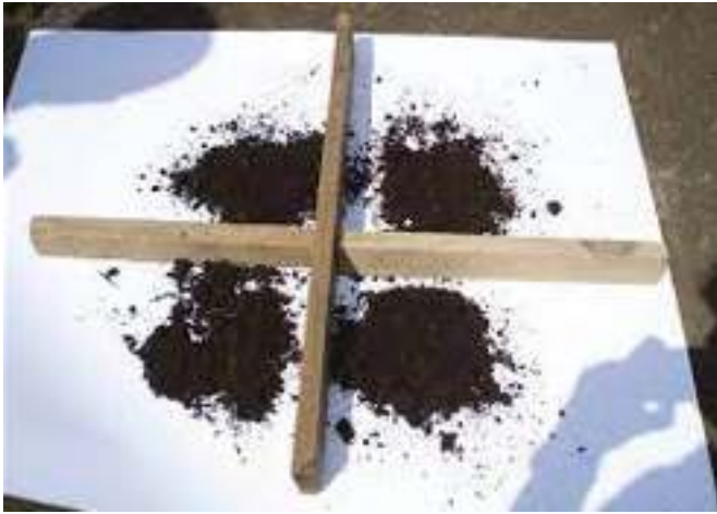
Figura N° 6. Cuarteo de muestra extraída.
