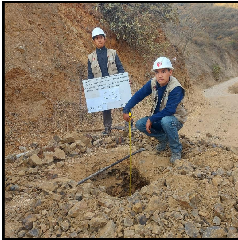
Calicata de un metro cuadrado por metro y medio de profundidad con su respectivo cartel de identificación – Calicata 04
