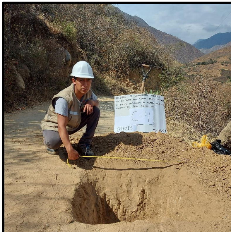
Calicata de un metro cuadrado por metro y medio de profundidad con su respectivo cartel de identificación – Calicata 04
