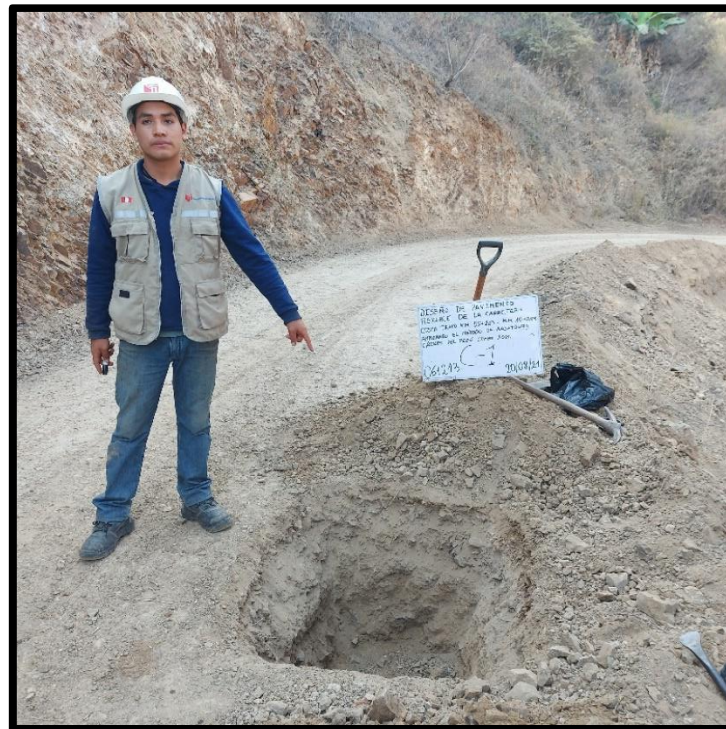
Calicata de un metro cuadrado por metro y medio de profundidad con su respectivo cartel de identificación – Calicata 02
