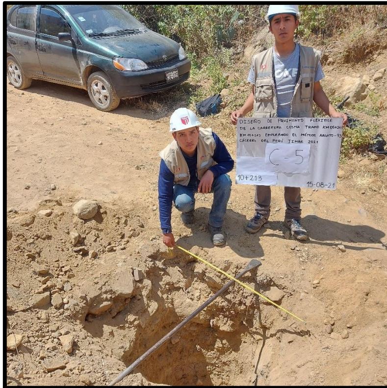
Calicata de un metro cuadrado por metro y medio de profundidad con su respectivo cartel de identificación – Calicata 05
