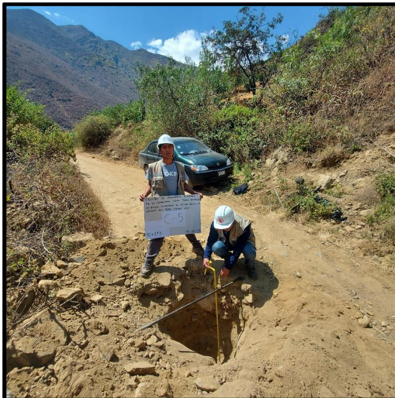
Calicata de un metro cuadrado por metro y medio de profundidad con su respectivo cartel de identificación – Calicata 05
