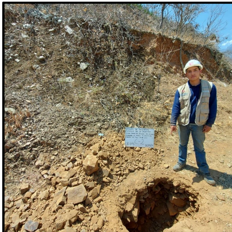
Calicata de un metro cuadrado por metro y medio de profundidad con su respectivo cartel de identificación – Calicata 02
